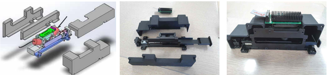
그림 94 내부 부품 설계 및 가공조립 (방열판 포함)
