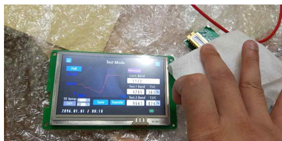
그림 67 TE-cooling Back-thinned CCD test - 1/2 Open
