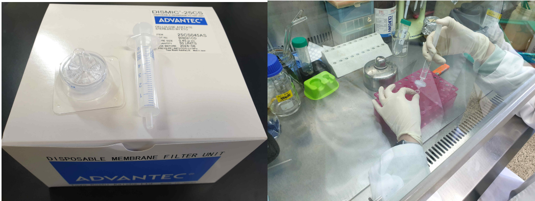
그림 55 단백질의 흡착율이 낮은 상용화된 필터를 이용한 분변샘플 필터링
