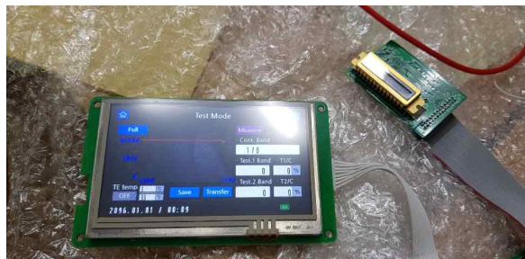
그림 66 TE-cooling Back-thinned CCD test - Open
