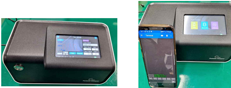
그림 98 실제 제작된 시제품 및 무선 통신 이미지
