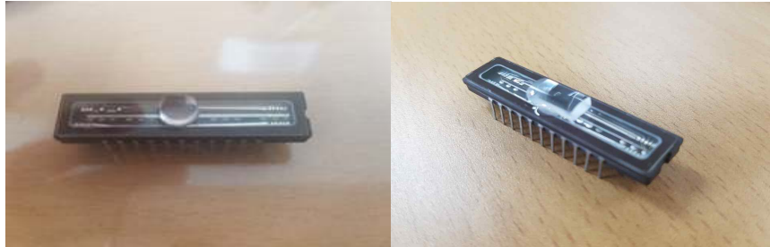
그림 15 집광 cylinder lens 제작 예
