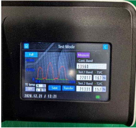
그림 99 표준 발광 물질을 이용한 시제품 평가
