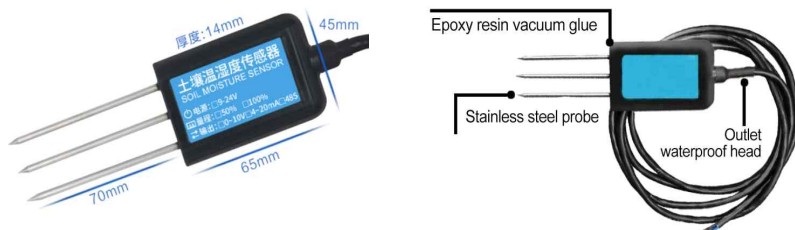
그림 132 영농형 태양광 토양 온습도 센서 규격
