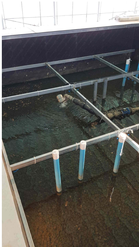
그림 7-22. 4차 함양시험 100 m 3 /d 주입 시 현황
