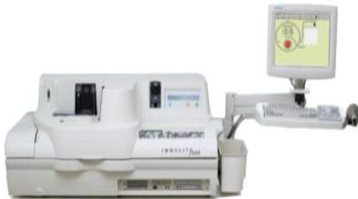
그림 45. 혈청프로게스테론 농도 측정에 사용된 Immolute 1000 (Siemens Healthcare Diagnostics Inc., Flanders, NJ).
