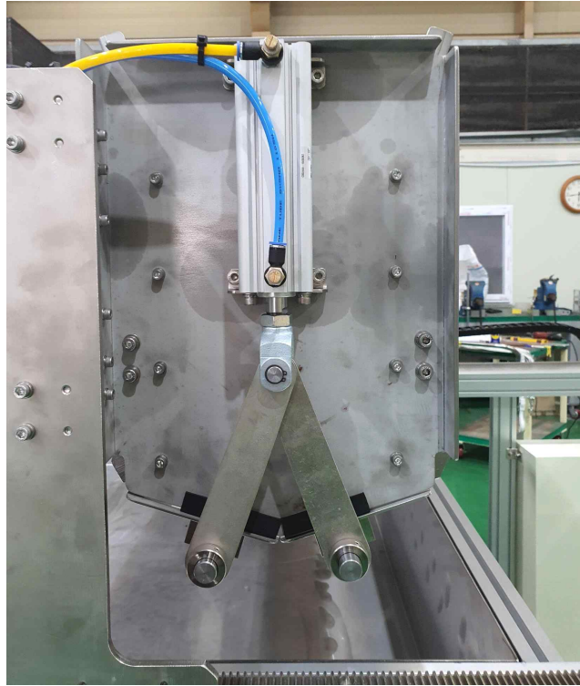
그림 46 배지 공급용 임시 호퍼 및 개폐 장치
