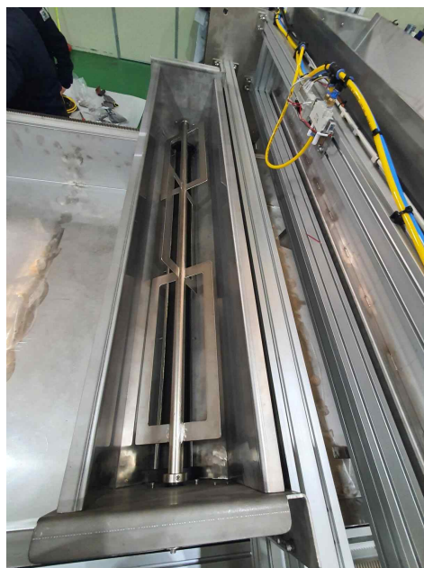
그림 47 먹이 살포장치의 호퍼 및 믹서 블레이드
