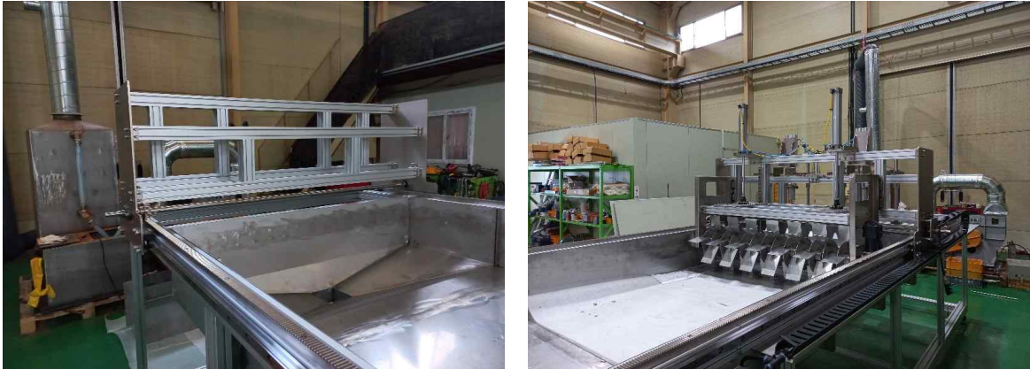
그림 44 배지와 먹이 공급부의 프레임 및 구성부 조립 모습
