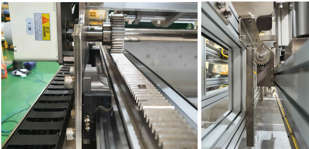
그림 52 배지, 먹이 공급 및 교반용 선형 운동에 적용된 랙피니언과 LM가이드
