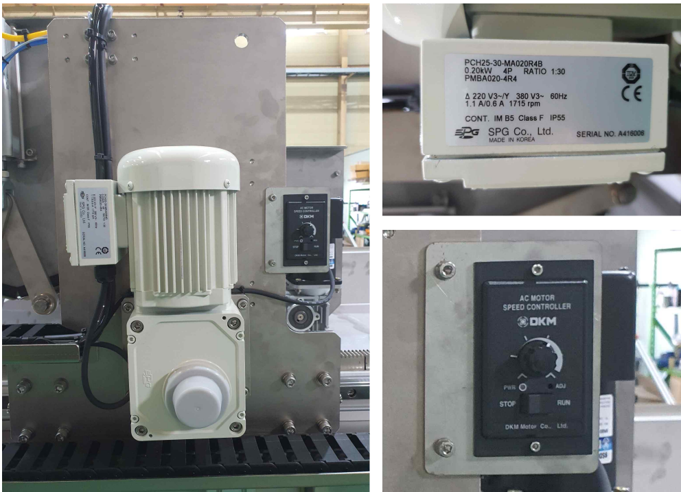
그림 65 배지, 먹이 살포 및 교반 장치 이송 모터와 스피드 컨트롤러
