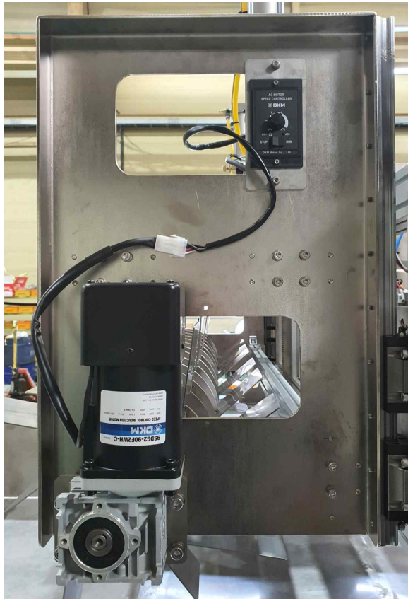
그림 66 교반 장치의 구동용 모터와 감속기
