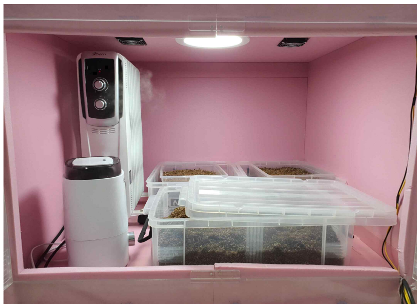
그림 76 4번 사육 박스의 구성(가습기, 라디에이터 및 LED)
