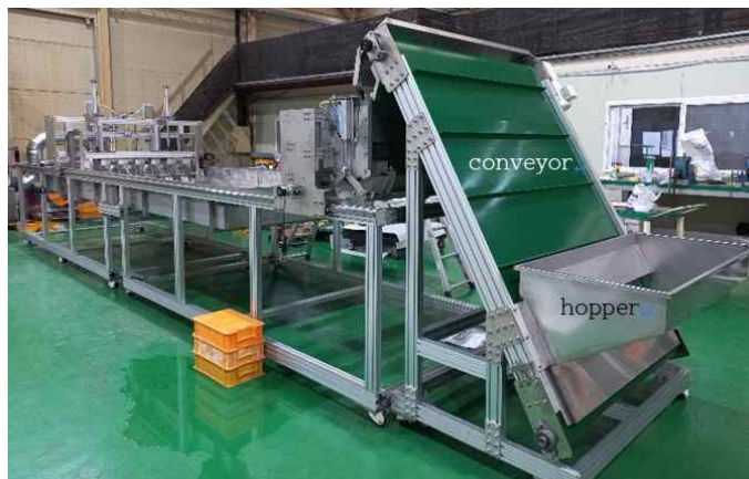
그림 43 이송부 및 컨테이너의 제작 모습
