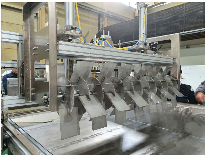
그림 50 배지 교반 장치와 상하 위치 제어용 에어 실린더의 구성 모습
