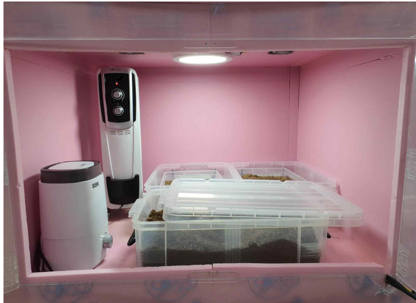
그림 75 3번 사육 박스의 구성(가습기, 라디에이터 및 LED)
