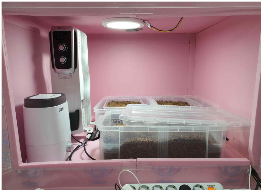
그림 74 2번 사육 박스의 구성(가습기, 라디에이터 및 LED)
