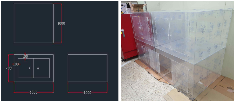
그림 68 사육 박스의 도면과 제작 모습
