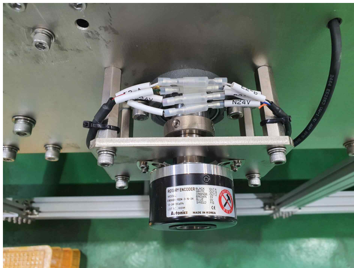
그림 67 배지, 먹이 살포 및 교반 장치용 엔코더
