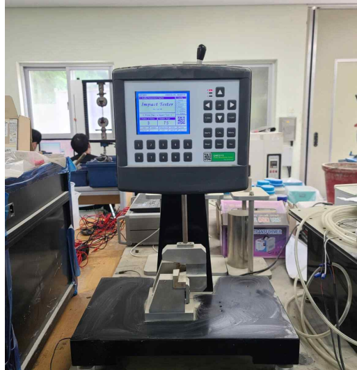
〈Fig. 3-118〉 아이조드 충격강도시험기 모습
