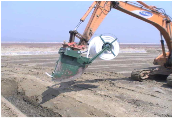
<Fig. 3-9> 농어촌연구원에서 개발한 무굴착암거설치 장비
