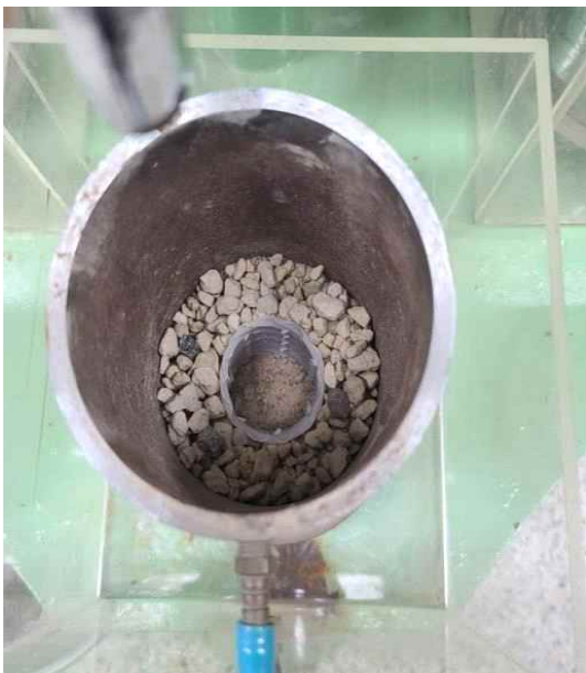
<Fig. 3-121> 유공관 시편을 잘라서 넣은 모습
