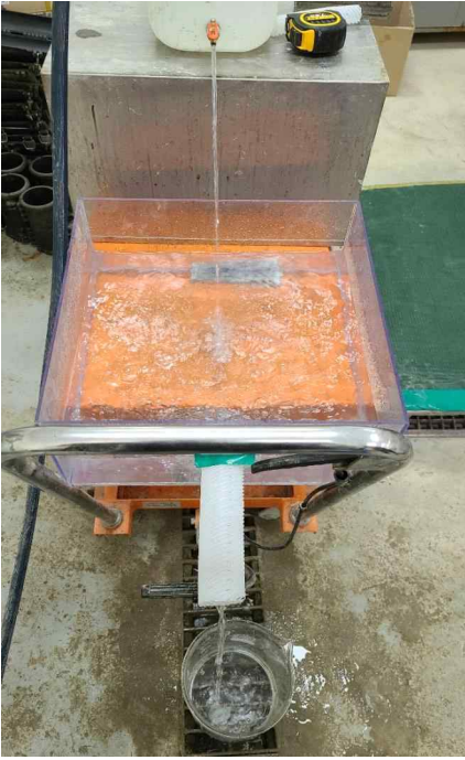
<Fig. 3-126> 유공관 통수능 시험을 실행하는 모습
