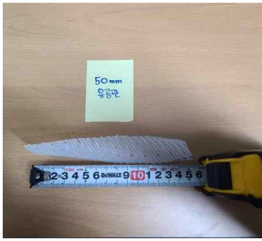
<Fig. 3-114> 50 mm유공관 암거 측정 시편 준비 모습
