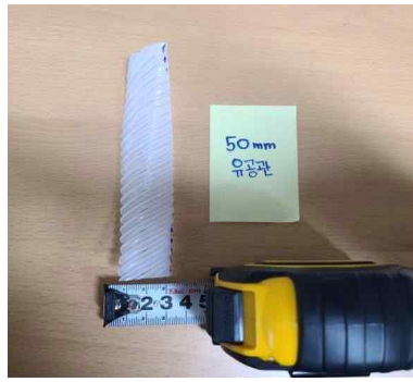
<Fig. 3-114> 50 mm유공관 암거 측정 시편 준비 모습
