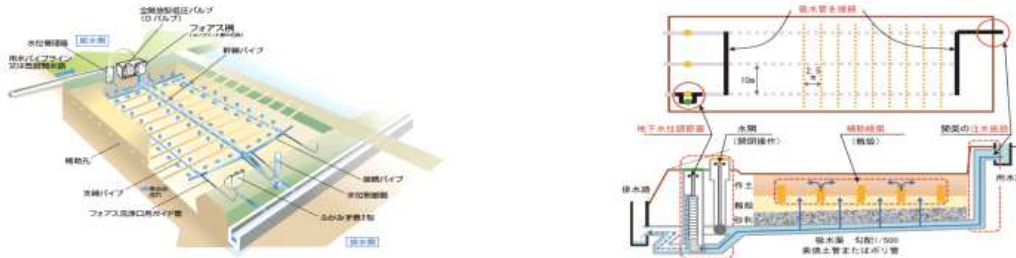
<Fig. 1-8> 일본의 지하암거배수시스템
