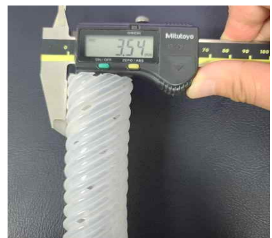
<Fig. 3-113> 30 mm유공관 암거 측정 시편 준비 모습
