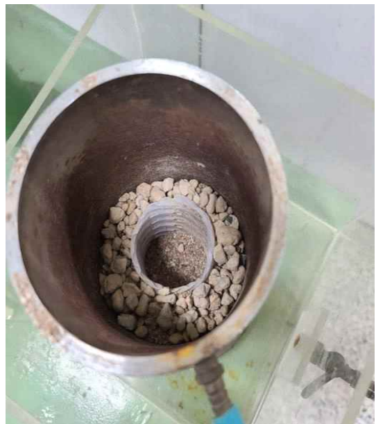
<Fig. 3-121> 유공관 시편을 잘라서 넣은 모습
