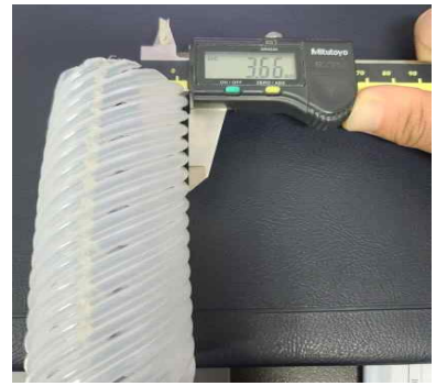
<Fig. 3-114> 50 mm유공관 암거 측정 시편 준비 모습
