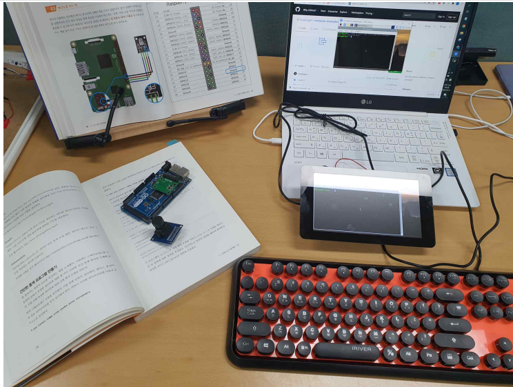
<그림> 라즈베리파이와 카메라 모듈 연결을 완료한 모습
