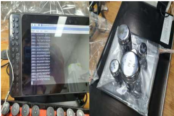
그림 248. 분동(2,000g) 및 로드셀 측정치(2,002g)
