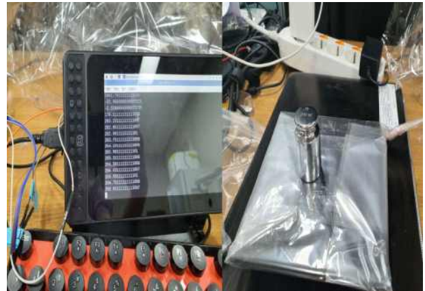
그림 247. 분동(200g) 및 로드셀 측정치(202g)
