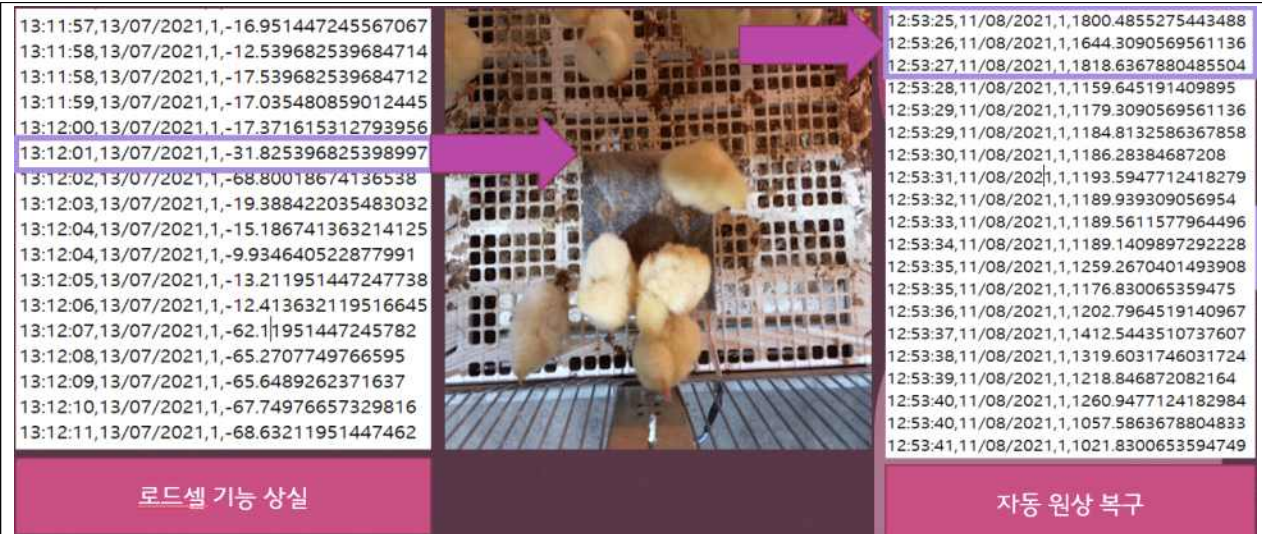
그림 256. 1차 실증 실험용 로드셀의 문제점 (불규칙적으로 반복적인 비정상적 음수 수치 출력 및 자동 원상 복구의 반복)
