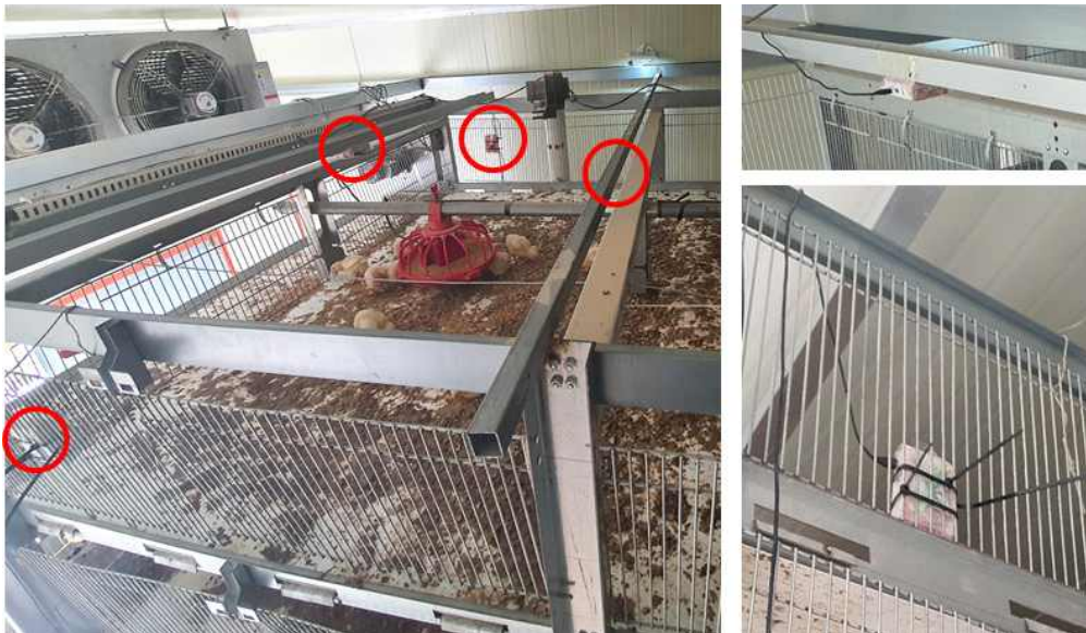
<그림> 개발 중인 양계시스템에 설치된 영상 장치
