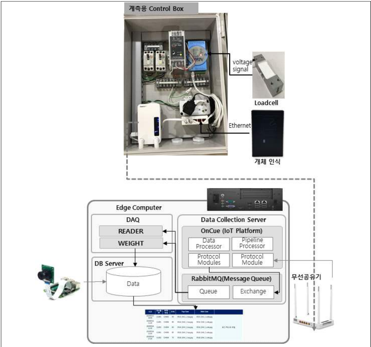
<그림> 무게 측정 내부 시스템 구성도
