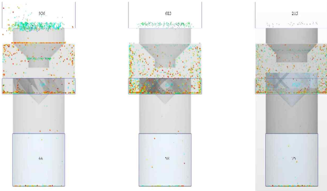
그림 12 날개 형상 및 단면적에 따른 분진 거동 해석 결과
