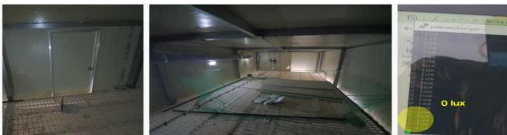
그림 39. 내부 최소 조명 및 문을 모두 폐쇄한 환경에서의 BH 1750 조도. (0 lux)
