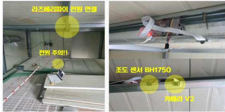
그림 38. 다층평사형 내부에 설치된 라즈베리파이
