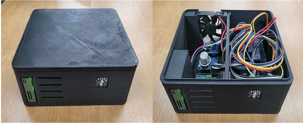
그림 58. 완성된 복합환경센서모듈의 모습과 내부 구성
