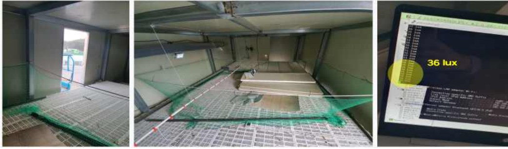
그림 40. 내부 최소 조명 및 1개의 문을 개방한 환경에서의 BH 1750 조도. (36 lux)
