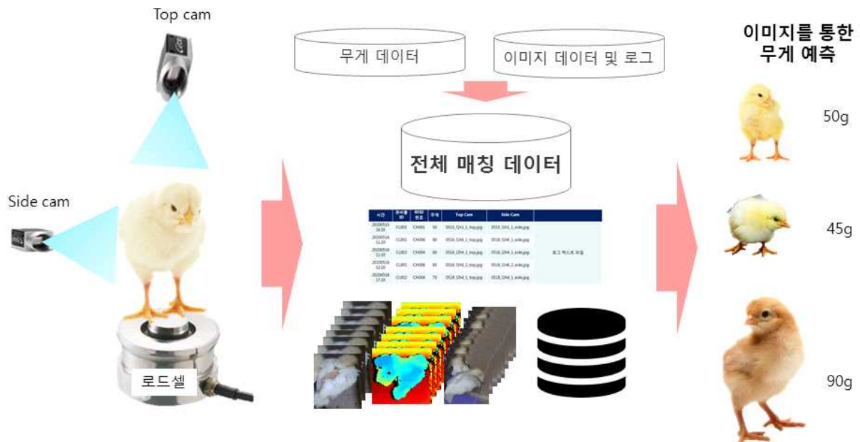
<그림> 무게 측정 및 모니터링 시스템 모식도
