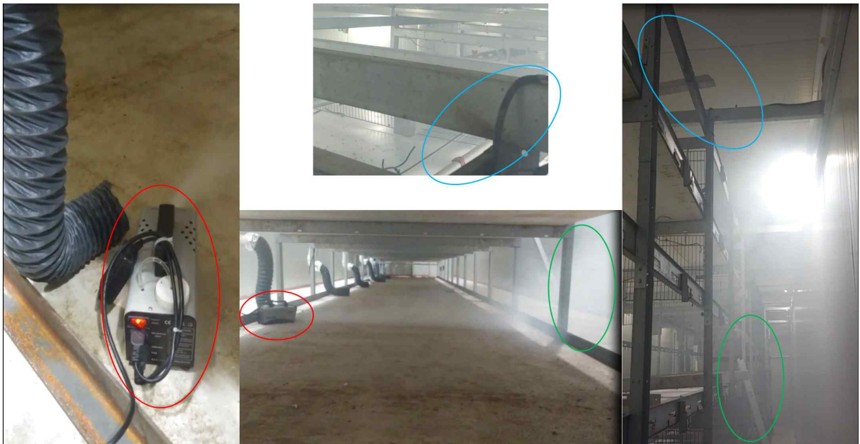
그림 8 하단의 스모그가 벽면을 타고 상부에 도달한 모습
