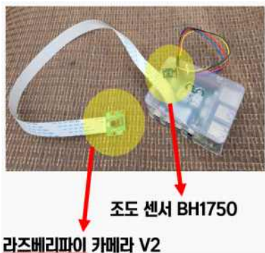
그림 37. 라즈베리 파이에 설치된 조도 센서 및 카메라
