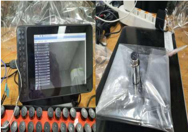
그림 246. 분동(100g) 및 로드셀 측정치(102g)
