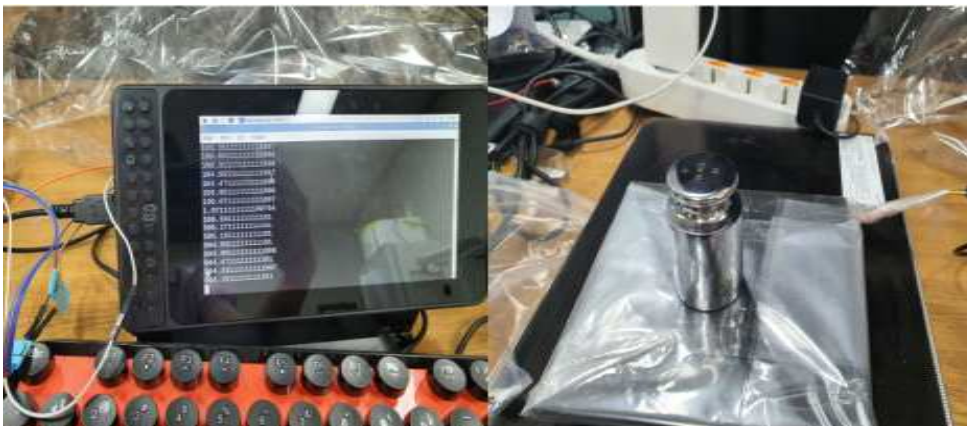
그림 250. 분동(500g) 및 로드셀 측정치(504g).
