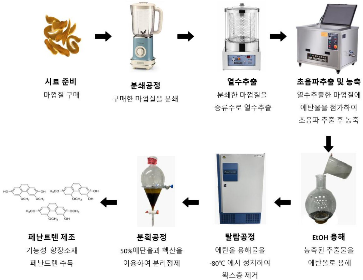
그림 34. Scale-up 최적 생산 조건 모식도
