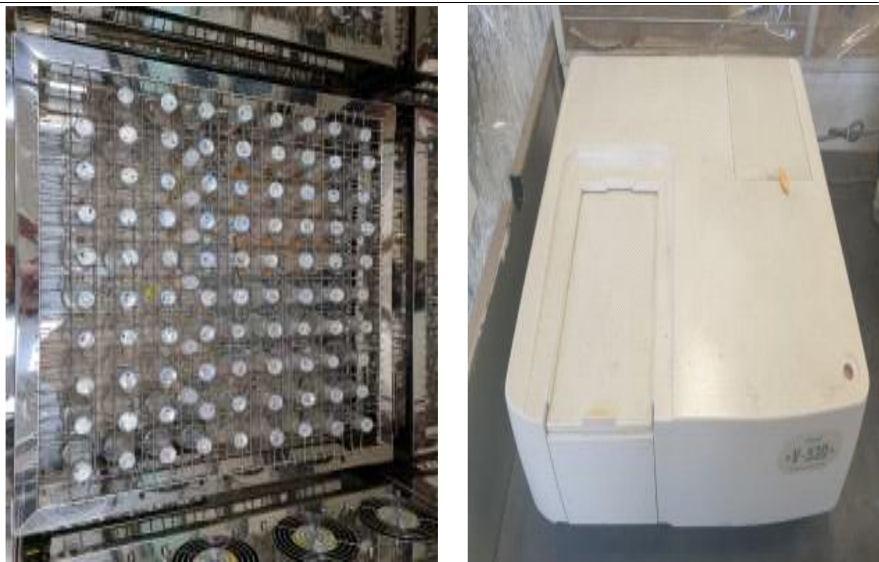
[그림3-19] TB B1-B5( B. licheniformis )균주 비율별 질소원 대량배양 및 흡광도 기기
