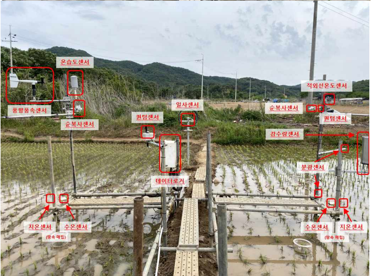
<그림 13> 2년차 처리구 및 대조구 센서 설치 사진
