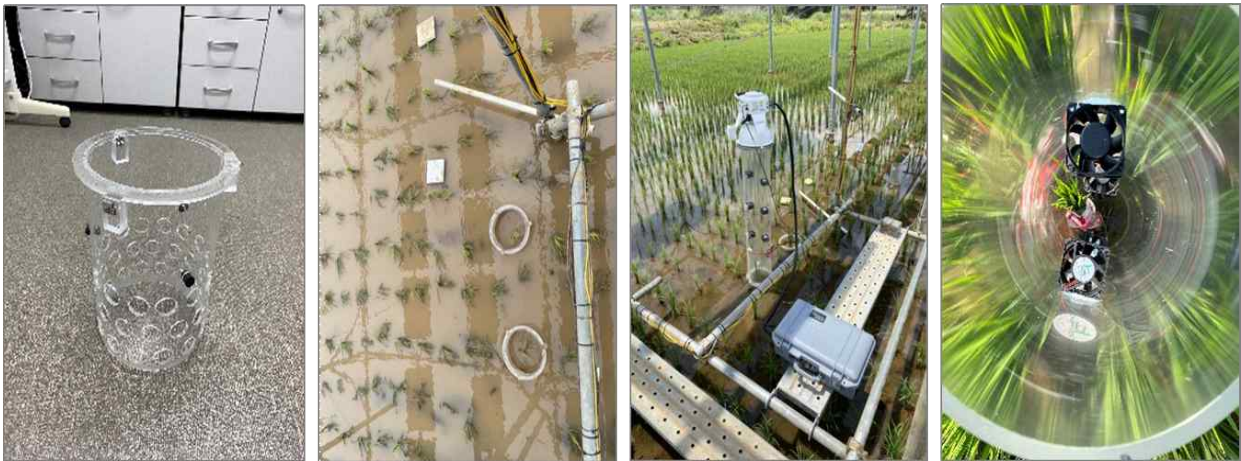
<그림 24> 관측에 사용된 아크릴 collar의 형태와 현장 설치 모습
