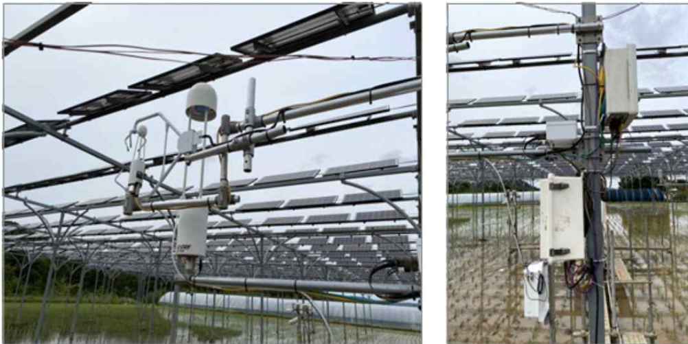
<그림 19> 파주 관측지에 설치된 에디 공분산 시스템
