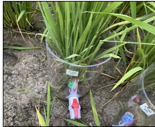
<그림 21> 미니 라이시미터 설치 모습
