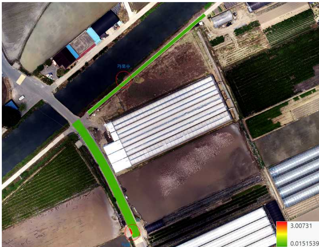
그림 2-5-2-14. 연구부지 주변의 침하 모니터링 결과
