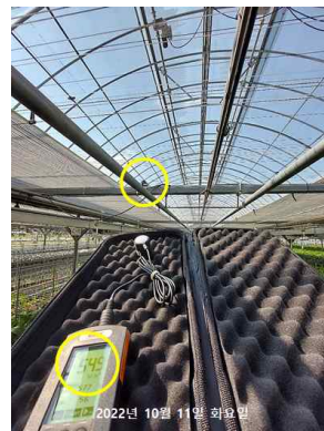
그림 2-5-1-3. 융복합 에너지팜 모니터링 하드웨어(HW) 플랫폼 구축: (가) 대기 및 하천수 온도센서(RTD) 설치, (나) ATES용 전자기 유량센서 교정성적서 발급 및 설치, (다) 기계실 및 온실 설치 센서 연결 공사, (라) 온실 내부 설치 광센서 교정실험
