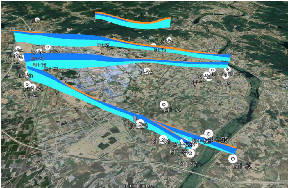
그림 2-3-2-3. 연구부지 일대 총적층 분포를 평가하기 위한 총적층 단면도
