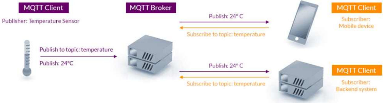
그림 136 MQTT 통신 아키텍처 (www.mqtt.org)
