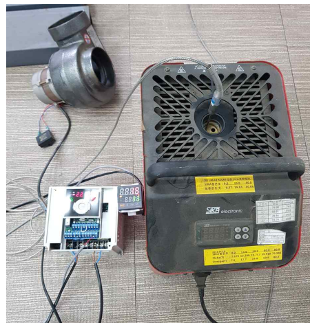
그림 117 제어기-센서-송풍기 간 연결
