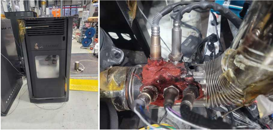
[그림 403] 램다 센서 내구성 테스트용 스토브
