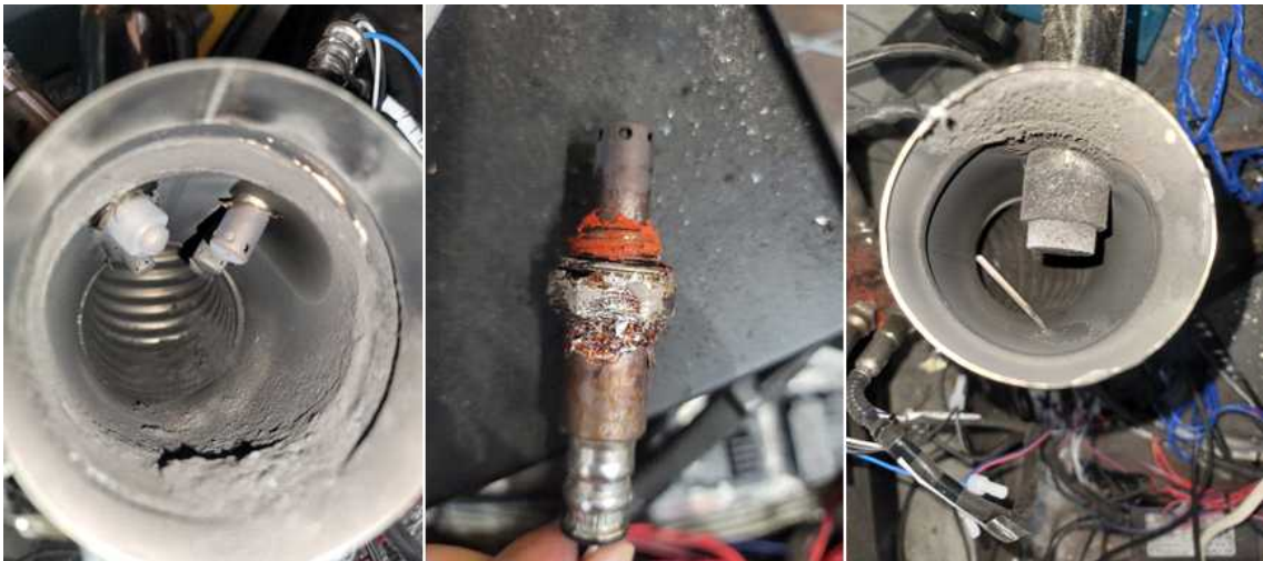
[그림 404] 연소 이후 센서 상태
