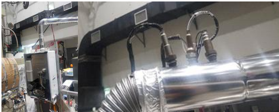
그림 111 람다 센서 가정용 보일러 설치 및 내구성 실험
