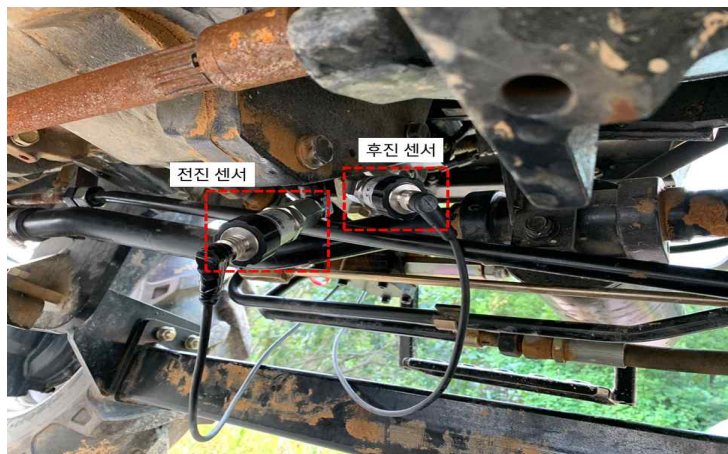
그림 X. 트랙터에 설치된 HST의 전/후진 펌프 유압 센서
