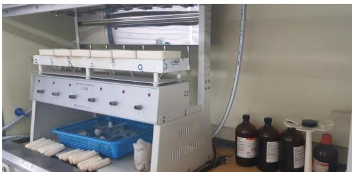
Fig. 20. Kjeldahl apparatus
