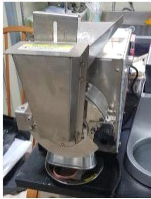
Fig. 16. 150 mesh Homogenizer
