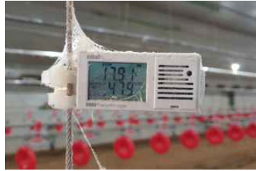
(a) 내부 온습도 측정용 센서 (b) 실험 농가에 설치 (c) 대상 농가에 설치하는 모습 <축사 내부 온습도 측정을 위한 설치 모습>
