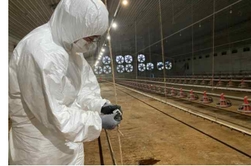
(a) 내부 온습도 측정용 센서 (b) 실험 농가에 설치 (c) 대상 농가에 설치하는 모습 <축사 내부 온습도 측정을 위한 설치 모습>
