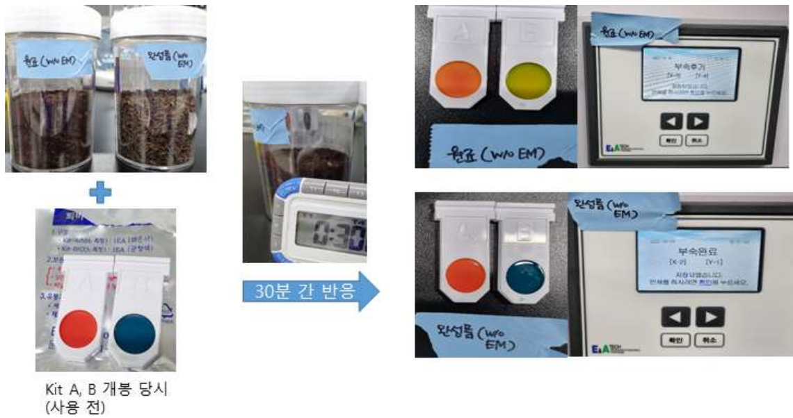
그림 30 콤팩 기기를 이용한 퇴비 부숙도 측정 방법 (예시)
