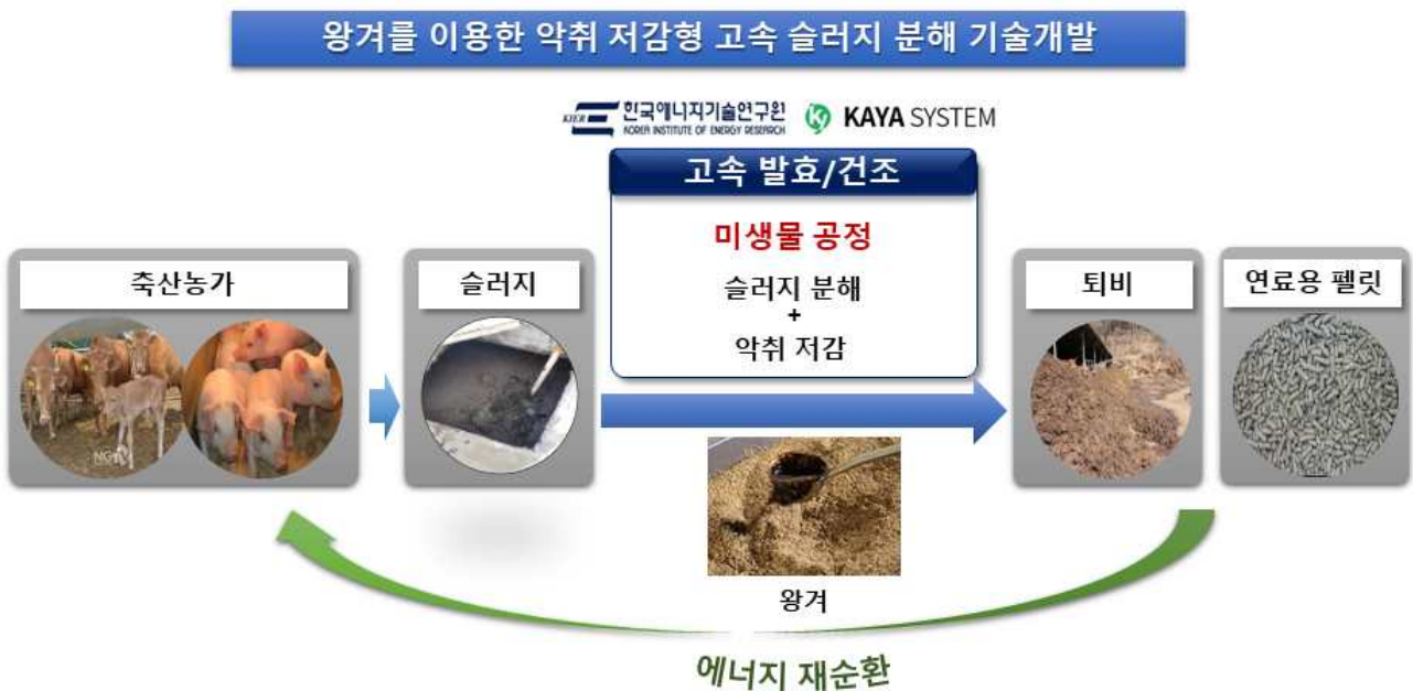
그림 1 고속 슬러지 분해 공정개발 모식도
