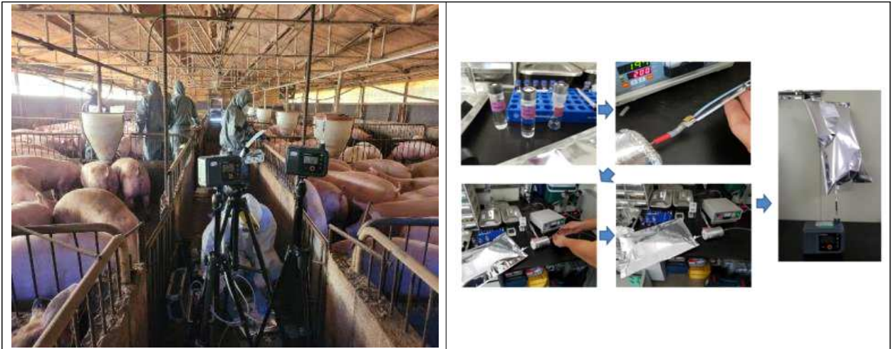
그림 27. 돈사 내부 에어샘플 분석 및 샘플포집 과정 설명
