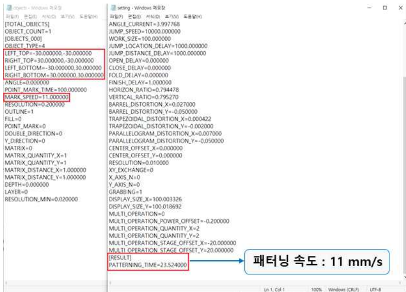
[그림 67. 자동 계산 프로그램을 통한 레이저 패터닝 속도 측정 결과]
