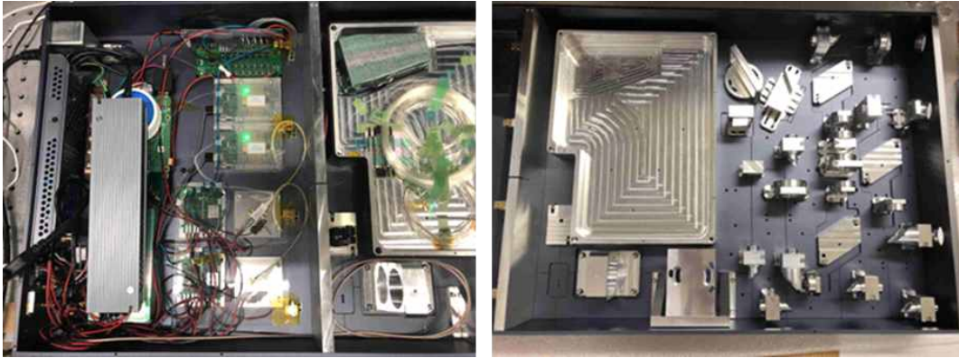
[그림 58. 좌) 전장부 구성 사진. power supply, LD & LD drivers, temperature controllers, main processor. 우) 광학부 구성 사진. 공진기, 증폭부, 압축단, 파장변환부 ]
