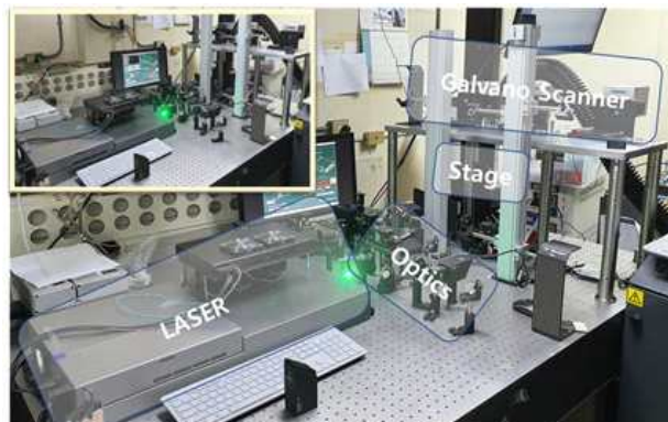
[그림14. 레이저 직접묘화 패터닝 시스템 구성 이미지]
