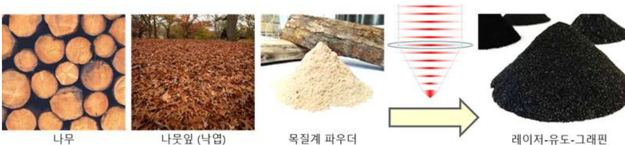
[그림 8. 다양한 목질계 미이용 바이오매스의 탄소전극화를 위한 레이저-유도-그래핀으로의 변환]
