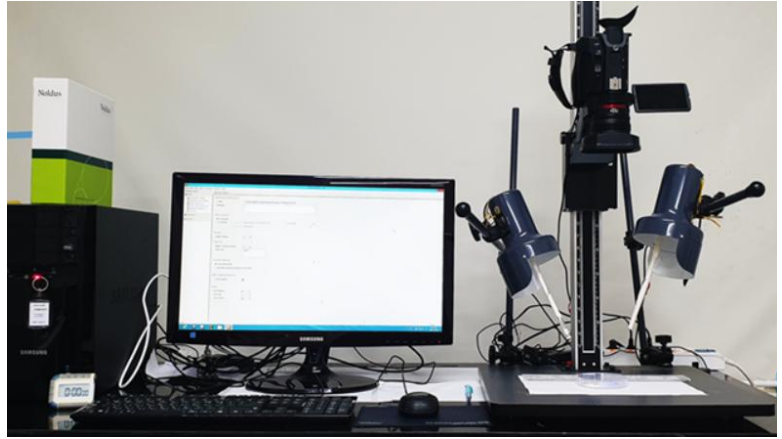
< 그림 3-4. LED에 의한 곤충행동의 변화 측정에 사용한 EthoVision 시스템 >
