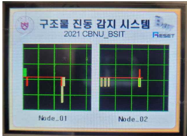
그림 75. Nextion 디스플레이 기반 시각화 구현.
