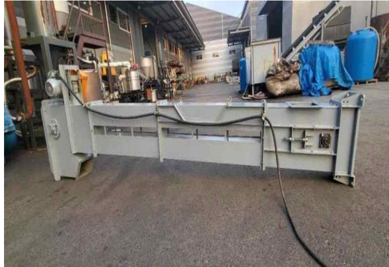
그림 93. 버킷엘리베이터 3D도면 및 실제 제작사진.
