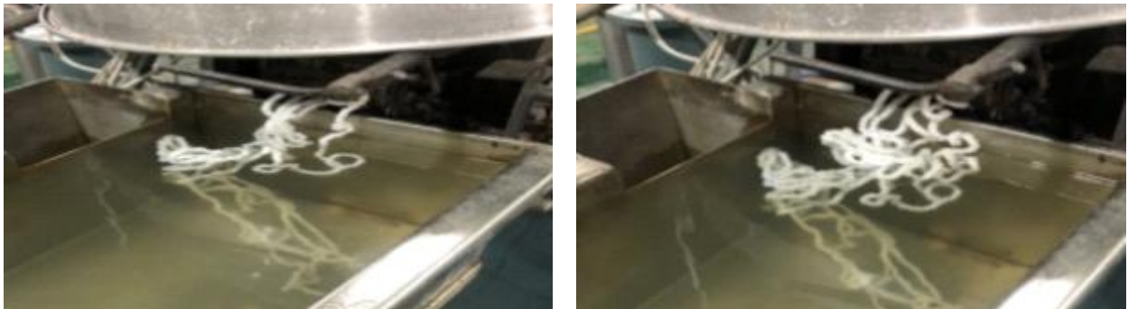
그림 47. 압출 작업간 첨가제 분산 및 결정화에 따른 불량발생
