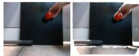
그림1. (a) RGB 이미지, (b) 깊이 이미지와 정렬을 통해 생성한 포인트 클라우드
