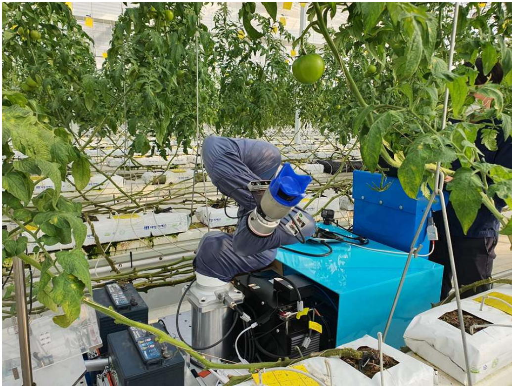
< 그리퍼 및 로봇 특성을 고려한 작업 위치 보정 및 파지 지점 선정(라이 ver.1) >
