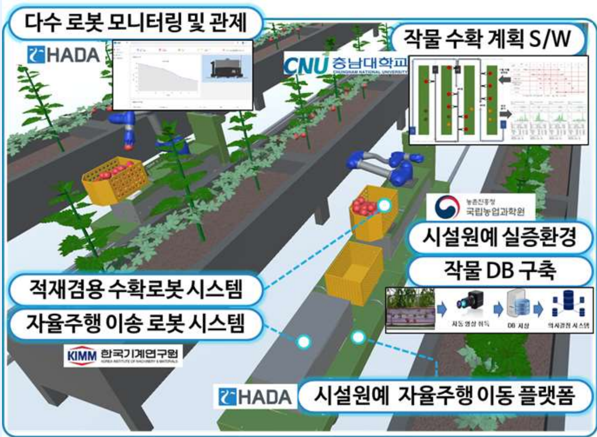
그림 5 다수로봇 협업기반 수확 로봇 시스템(안)
