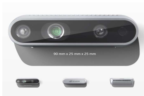
< Intel사의 realsense D435 RGB-D 카메라 >
