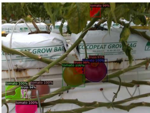
< Mask R-CNN 모델을 통한 토마토 꼭지와 토마토 위치 인식 결과 >
