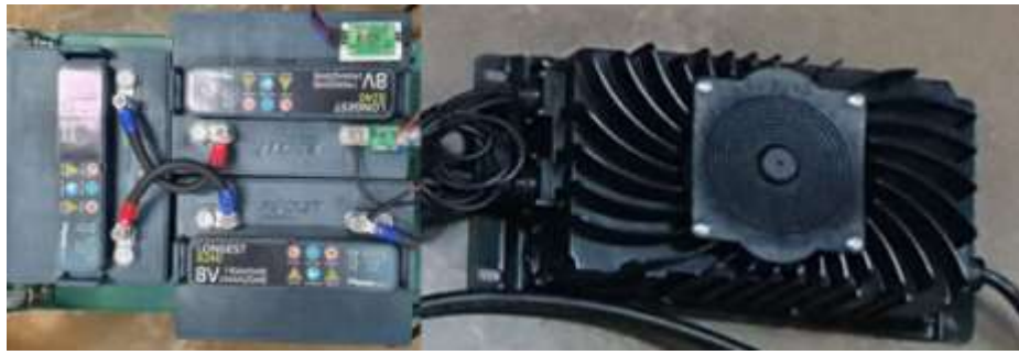
< (좌) 납축전지(L-8240)배터리, (우) 납축 배터리 전용 충전기 (FCF15-A-2430) >
