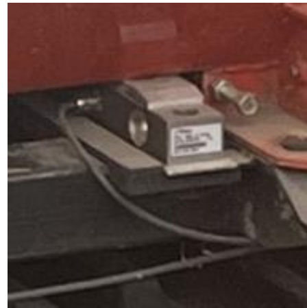
<곡물탱크 하중 측정 센서 Lay-out구성>
