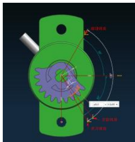
<예취높이센서 및 부착위치 Lay-out>
