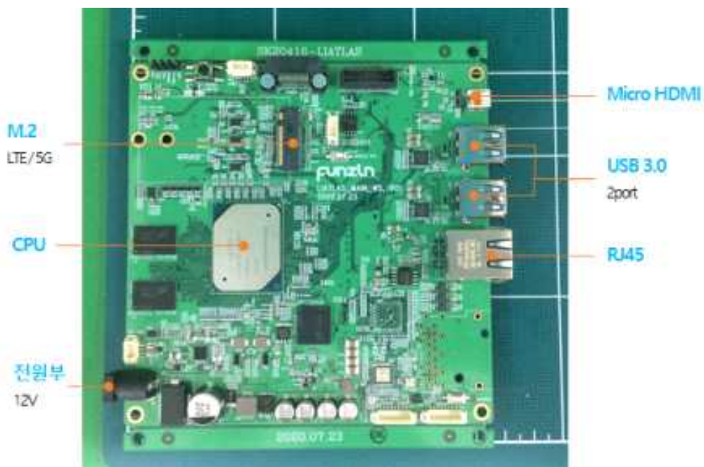
<컨트롤러 메인보드 앞면>
