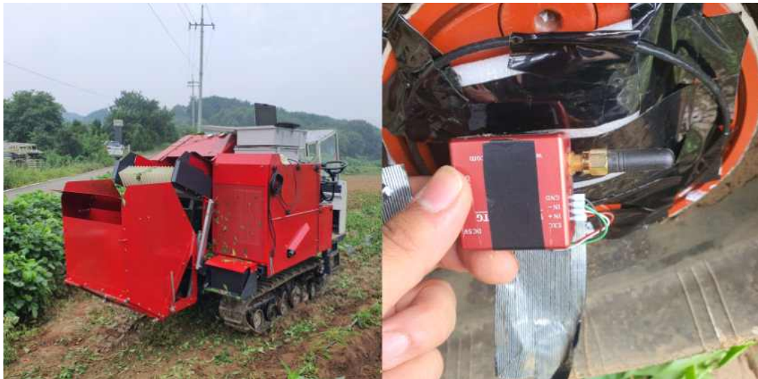
<계측시스템이 구비된 차량 및 무선 앰플리파이어>
