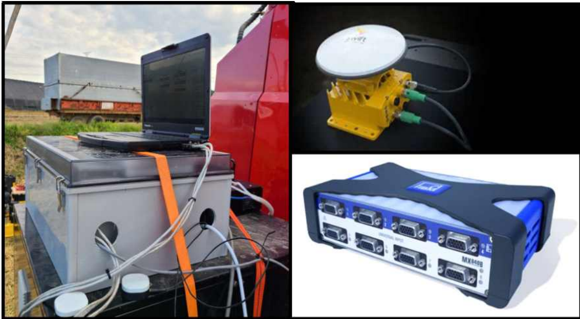
<계측시험에 사용된 계측시스템(좌), GPS (우상) 및 DAQ (우하)>
