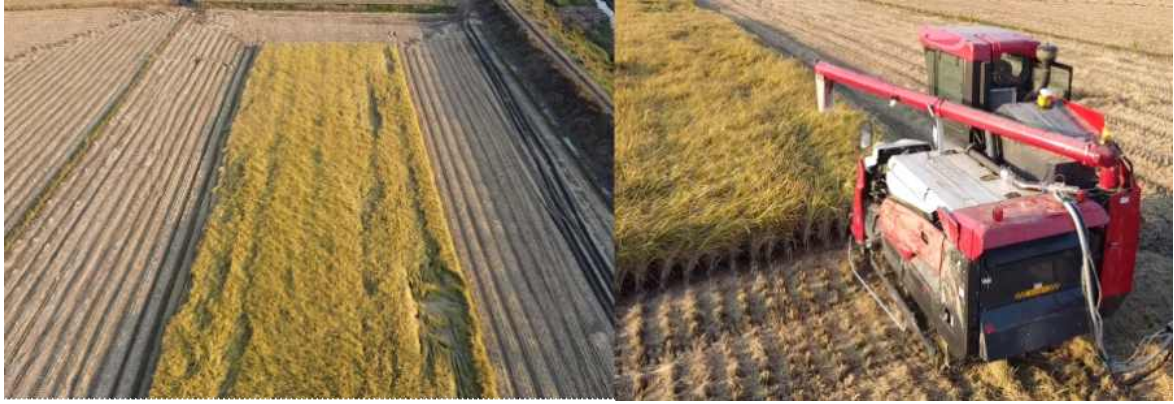
<부하 계측시험 필드(좌) 및 계측시험 콤바인(우)>
