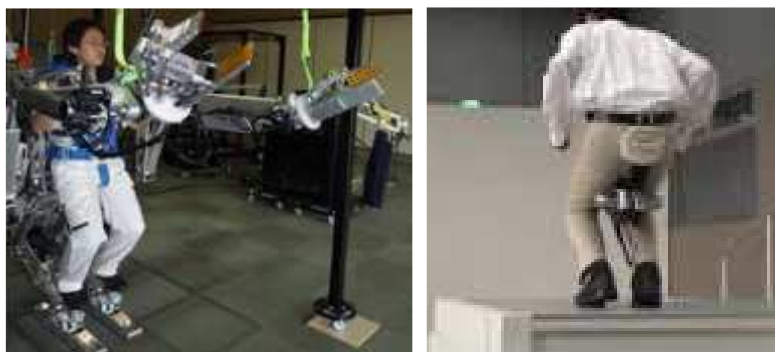
< 일본 웨어러블 슈트 개발 현황 >(좌: Power loader, 우:WAD)
