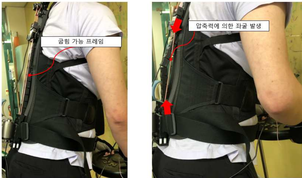
< 굽힘이 가능한 압축력지지 프레임을 도입한 외골격 로봇 시제품 사진 >
