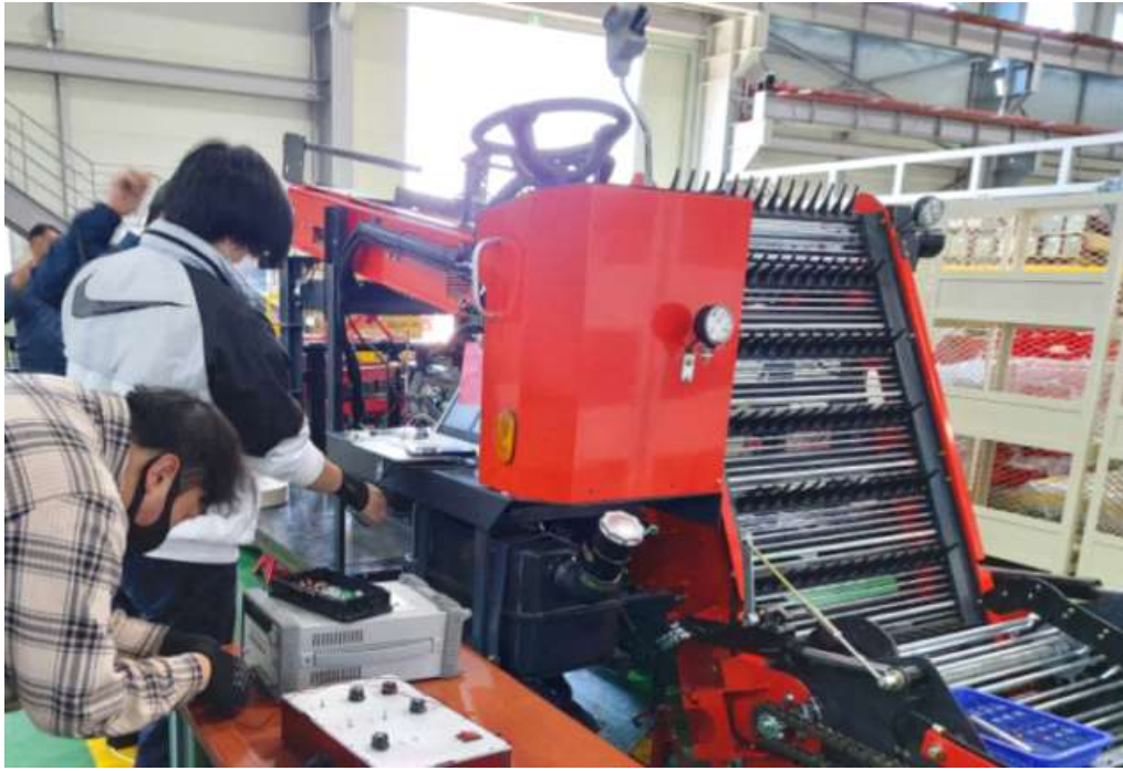
그림. 개발된 주행 제어 통합제어기 Simulator 및 진단 Software
