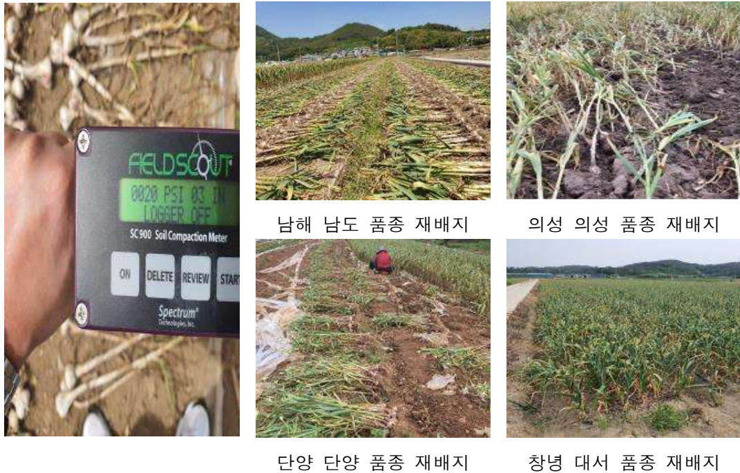
그림. 주산지별 재배 토양 Cone Index 측정
