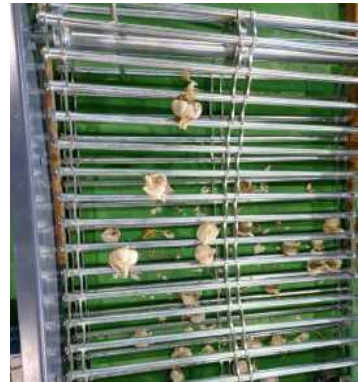
그림. 수집컨베이어 완성 및 마늘 빠짐 검토
