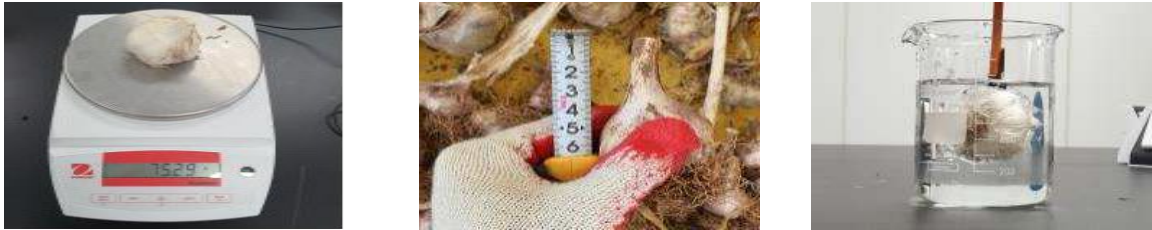
그림. 마늘 무게, 길이, 폭, 부피, 밀도 측정
