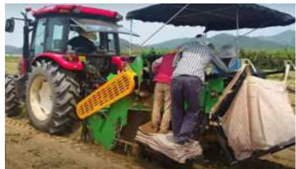
그림. 선별부 높이에 따른 선별 작업자 위험 노출 장면
