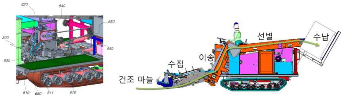
그림. 차속동조 기능을 가진 수집기 시스템
