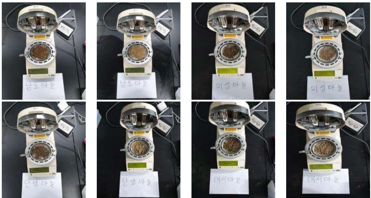
그림. 주산지별 재배 토양 함수율 측정
