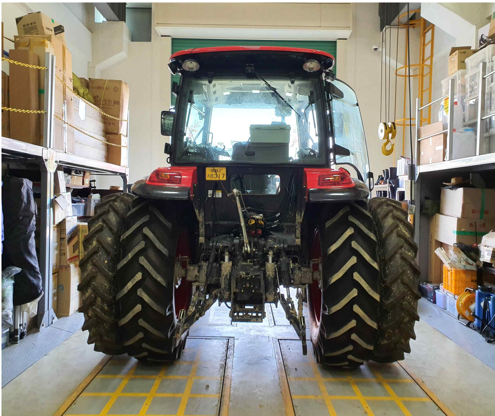
그림. 시작기 하중분포 측정의 예시
