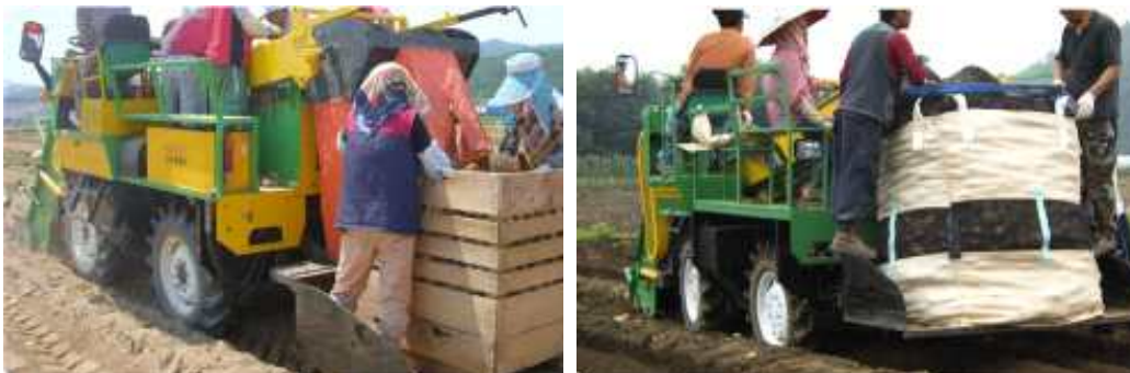
그림. 자주식 수확기 작업 시 낙하위험에 노출된 선별부 작업자 작업 장면
