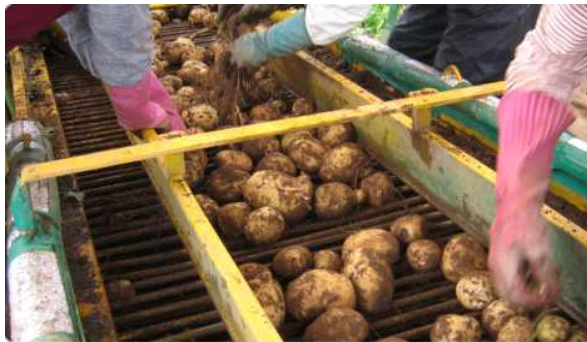
그림. 자주식 수확기 선별부 컨베이어에 작업자 손이 직접적 노출 장면
