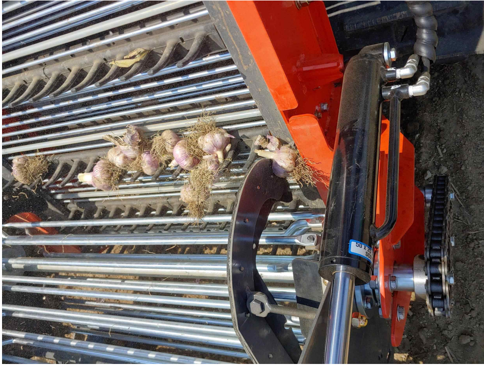
그림. 마늘수집기 이송부 마늘 및 이물질 끼임 현상
