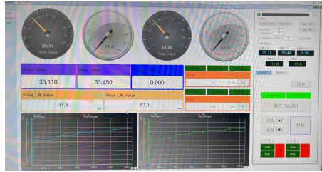
그림. 승용 자주식 마늘수집기 횡전도각 분석: (좌 : 분석 결과표 예시, 우 : 횡전도 분석 화면 예시)
