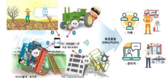
엔텍스가 개발한 농기계 충돌전파사고 실시간 감지 시스템 개요도다.
