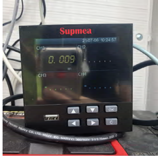
[그림 5-22] 초음파 수위계 설치 모습
