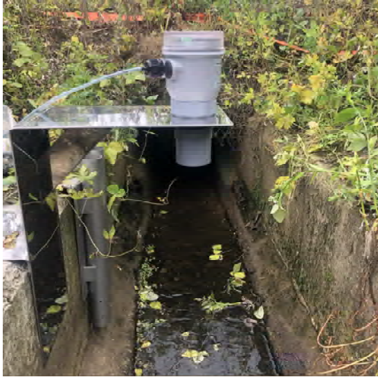
[그림 5-22] 초음파 수위계 설치 모습
