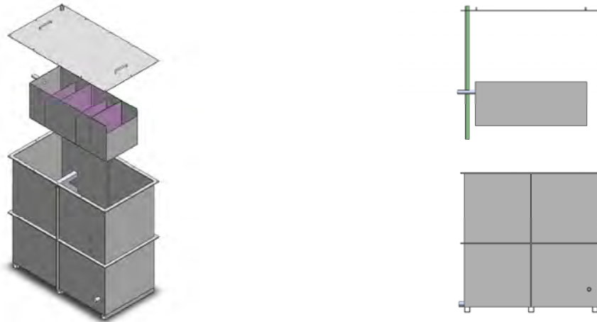
[그림 4-37] 수질정화 일체형 저류조 3D 설계
