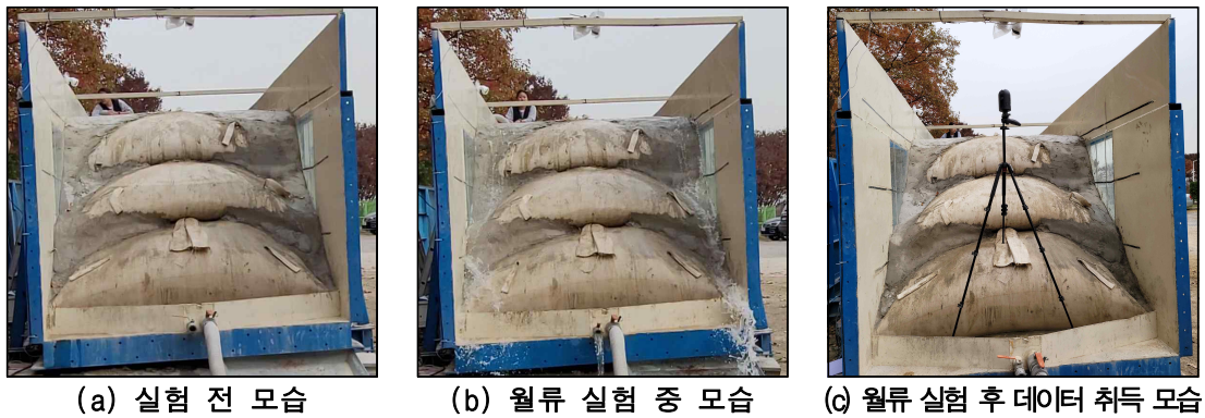
[그림 2-190] 결합재가 적용된 지오텍스타일 튜브 월류 실험 전경
