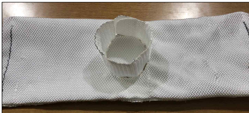
[그림 2-106] 다단 수리 모형실험에 사용된 지오텍스타일 튜브
