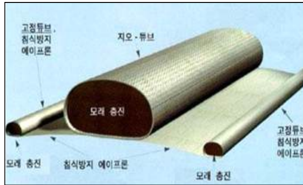
[그림 2-5] 지오텍스타일 튜브 개념도
