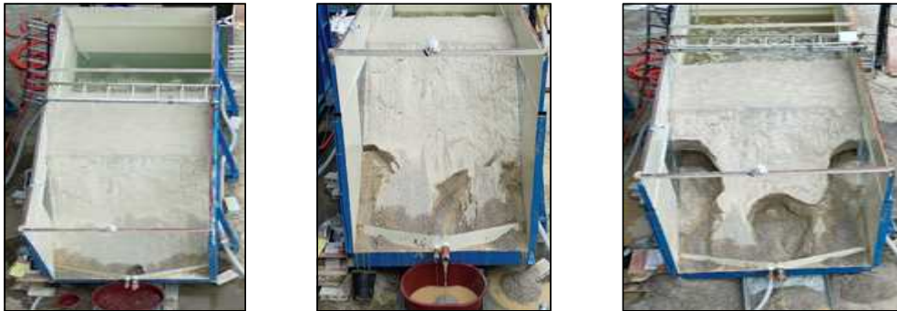
(a) 토출구 파이핑 현상 시작 (b) 토출구 파이핑 현상 심화 (c) 월류 실험 준비 중 배면 물채움
