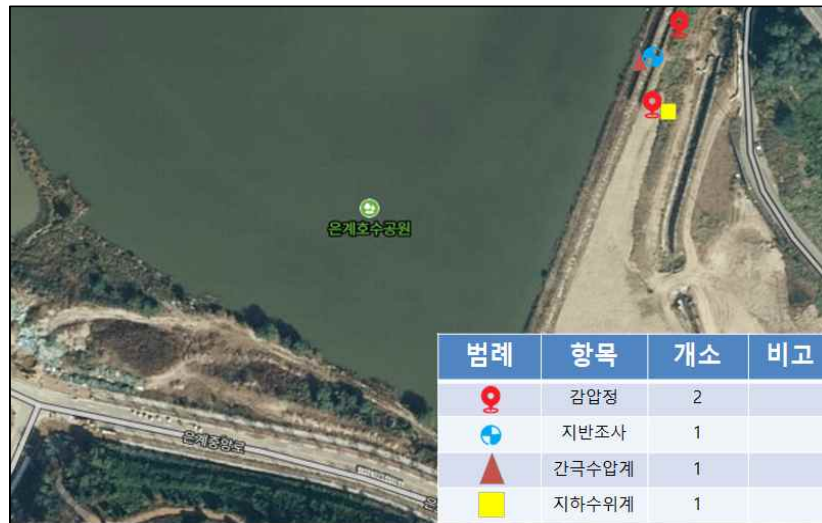
[그림 3-42] 감압정(은계호수공원) 계측 모니터링 위치
