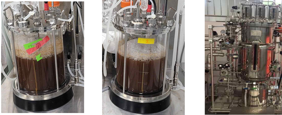
그림 16. 5L, 100L 발효기를 이용한 대량배양 최적 조건 확립
