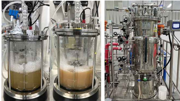
그림 5. 5~100L 발효기를 이용한 대량배양 조건 탐색
