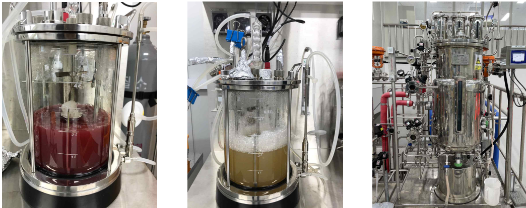
그림 9. 5L, 100L 발효기를 이용한 대량배양 최적 조건 확립
