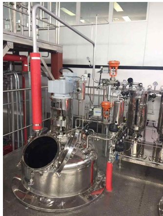
그림 17. 1.5톤 발효기를 이용한 대량배양 최적 scale-up
