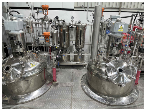
그림 6. 1.5톤 발효기를 이용한 대량배양 최적 조건 확립
