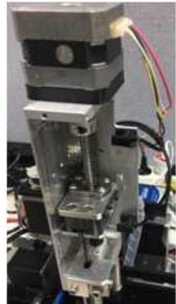
그림 49. 7인치 Touch LCD(좌)와 Pipette Axis(우)
