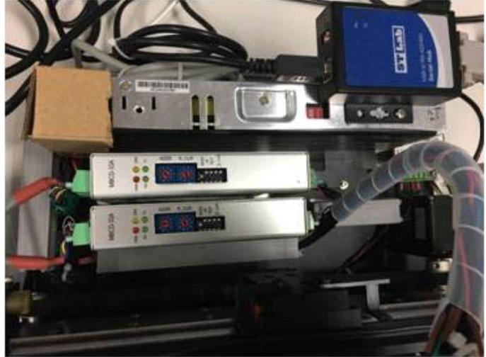
그림 48. PMT DRIVER(Offset 포함)(좌)와 SMPS 및 Motor Diver & 422Driver(우)
