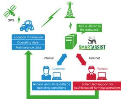
[Yanmar SmartAssist 서비스 구성 및 기능 출처 : Yanmar 홈페이지]
