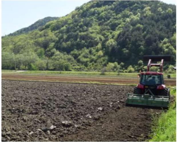
[부하 데이터 측정을 위한 쟁기/로타리 필드테스트 수행]
