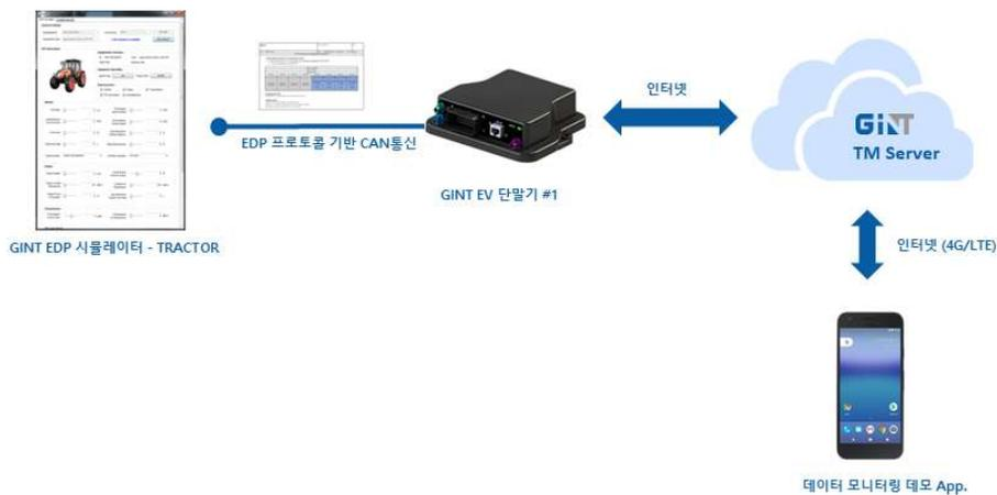
[TRACTOR 데이터 CAN 데이터 시뮬레이터를 통한 개발 검증]
