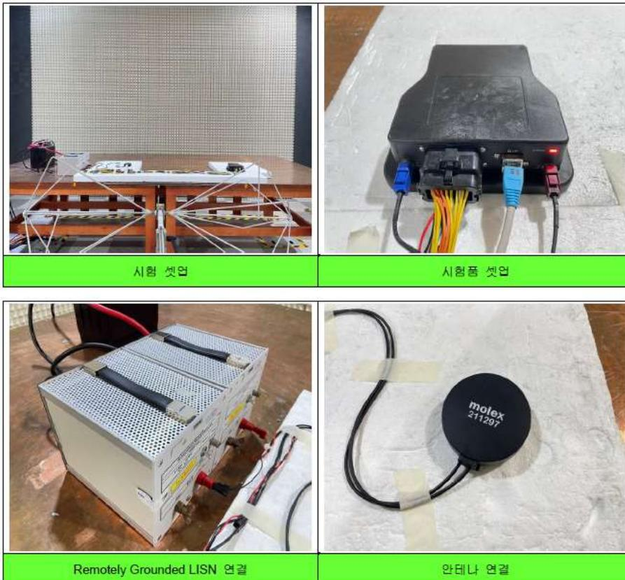
[ Radiated Emission 시험 사진 ]
