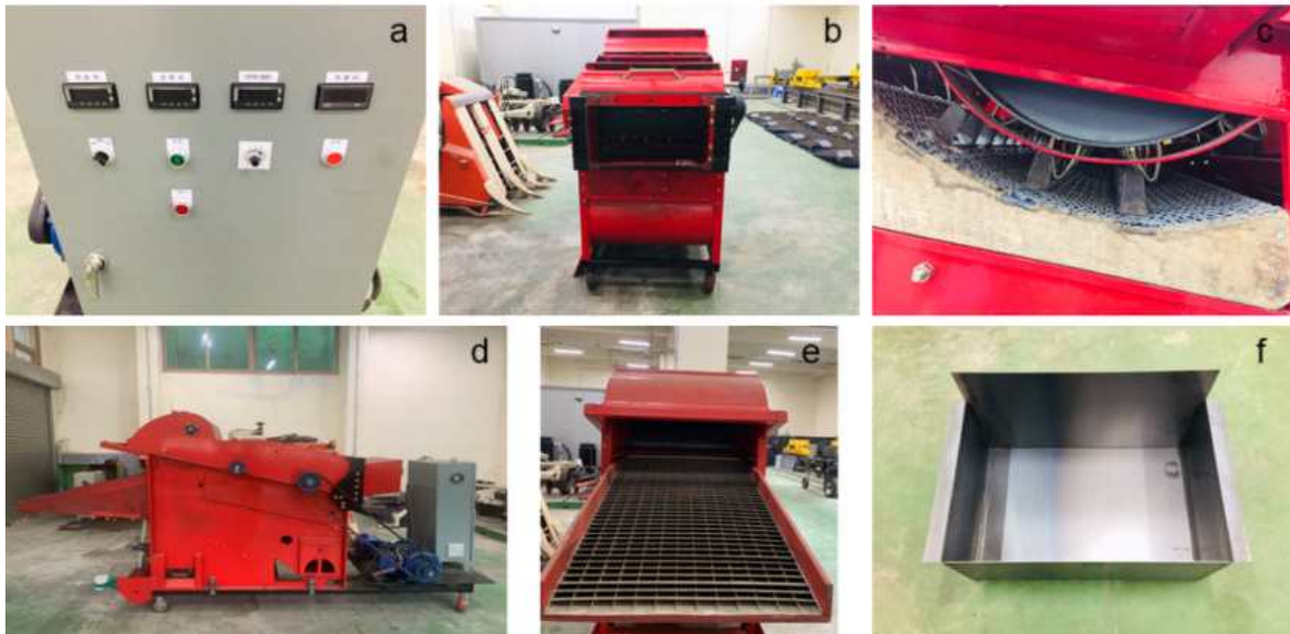
【 (a) 탈곡기 작동 컨트롤 박스; (b) 두류(콩) 투입구; (c) 두류(콩) 탈곡 작동부; (d) 탈곡기 외관; (e) 탈곡기 도출부; (f) 두류(콩) 덩불 받이 철판 】
