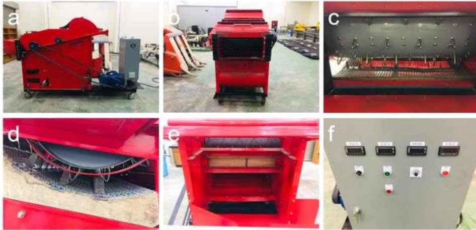
【 콩 콤바인 탈곡성능 시험 장치 (ABC 270, 오펜주식회사); (a) 측면도; (b) 정면도; (c) 탈곡통 및 급치, 선별부; (d) 탈곡부 측면; (e) 후면부; (f) 동력제어부 】
