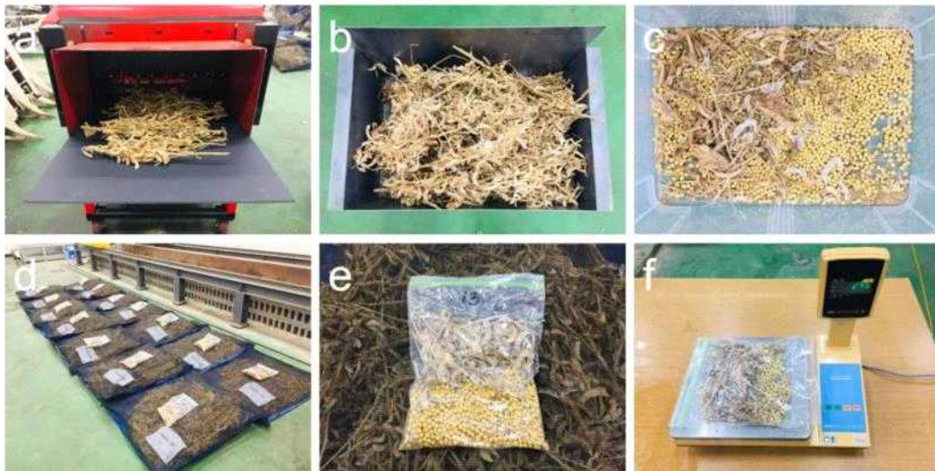
【 (a) 콩 콤바인 탈곡부 시험기 내 대상 작물 투입 방법; (b) 탈곡과정 후 검불받이 내 분리된 콩 대 및 검불; (c) 탈곡과정 후 분리된 콩 및 이물질; (d~e) 탈곡과정 후 분리된 샘플의 보관; (f) 탈곡과정 후 분리된 콩 및 이물질 무게 측정 】
