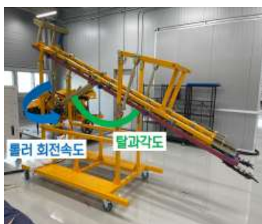
a. 시험요인 b. 작업광경-1 c. 작업광경-2 그림 25. 풋옥수수 수확기 탈과부 설계요인 최적화 시험
