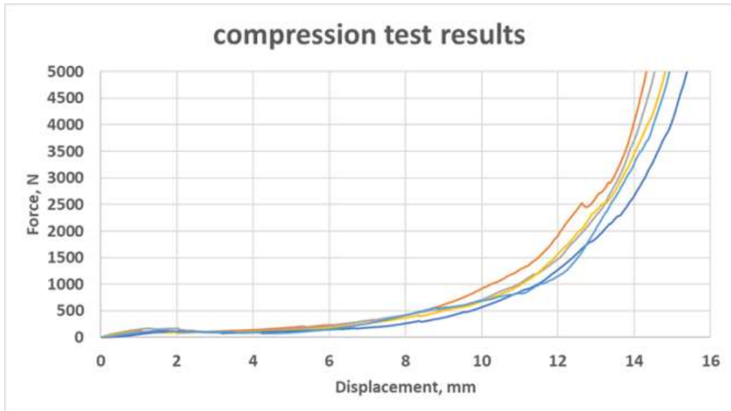
그림 52. 압축 시험을 통해 측정한 풋옥수수 줄기의 하중-변형량 관계
