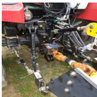
d. 토크미터 설치 및 계측기 연결
