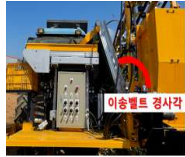
a. 미탈과 수확물 b. 수확물 미수집 발생 c. 수집부 이송벨트 경사각 그림 24. 통합시험장치 3차 작동시험 보완사항 도출
