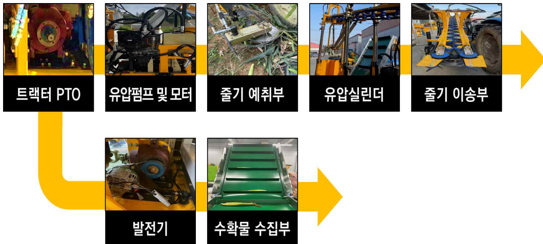
그림 45. 가변 제어형 풋옥수수 수확기 시작기 동력 전달체계
