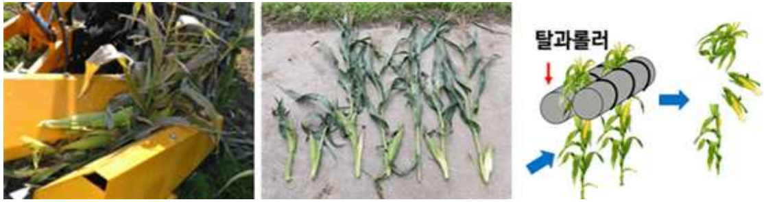
a. 슬립현상 b. 수확물 미탈과 c. Head-feed 방식 메커니즘 그림 19. 수확기 작업불량 현상 발생 및 Head-feed 방식 메커니즘
