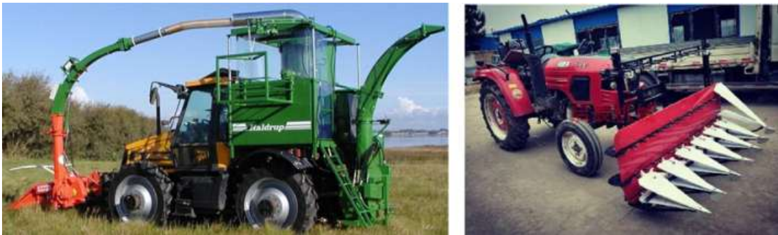
그림 5. 트랙터 전방 부착형 옥수수 수확기
