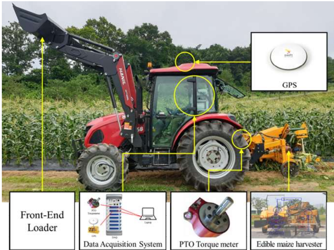
그림 48. 풋옥수수 수확 부하계측 시험 시스템 설명 및 개념도
