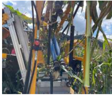
a. 미탈과 수확물 b. 수확물 미수집 발생 c. 수집부 이송벨트 경사각 그림 24. 통합시험장치 3차 작동시험 보완사항 도출
