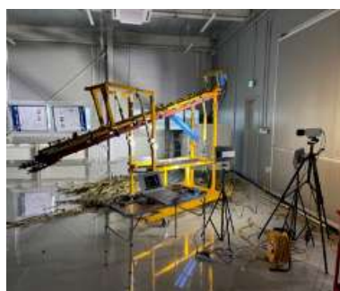
a. 시험요인 b. 작업광경-1 c. 작업광경-2 그림 25. 풋옥수수 수확기 탈과부 설계요인 최적화 시험
