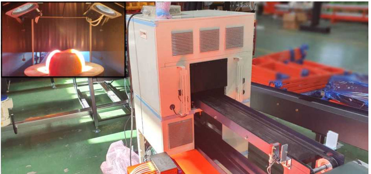
<프리트레이 방식에서 적정 광원의 각도와 거리가 적용된 반투과식 선별 시스템 구성>
