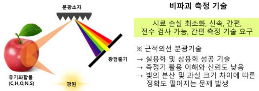
[그림 5] 비파괴 측정 원리 및 기술
