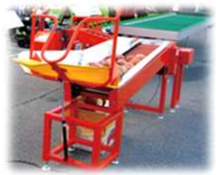
[그림 26] 기존의 gas cylinder를 이용한 반자동(수동) 덤프기
