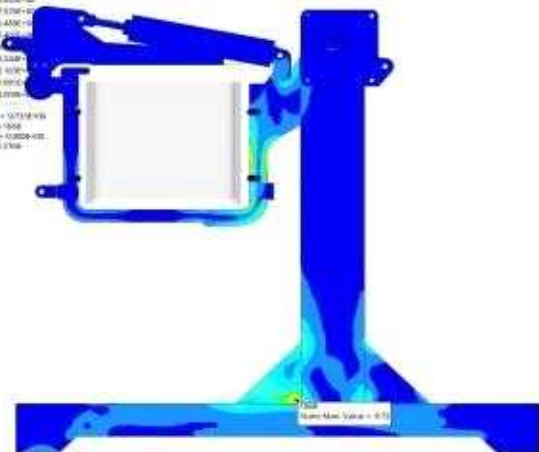
<수직부하 강도해석 결과(주요 부품별 응력분포)>
