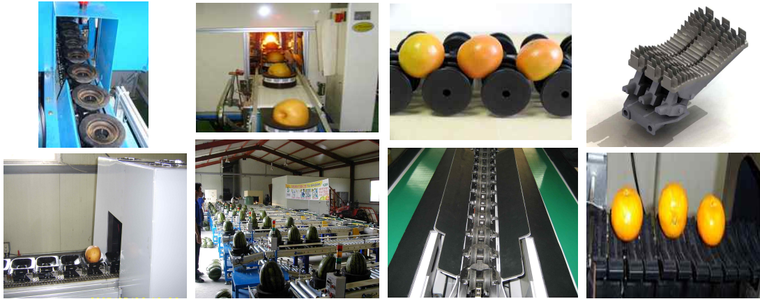
[그림 7] 이송방식별 비파괴 과일 선별기(컵방식-프리트레이방식-캐리어방식-피아노건반방식)
