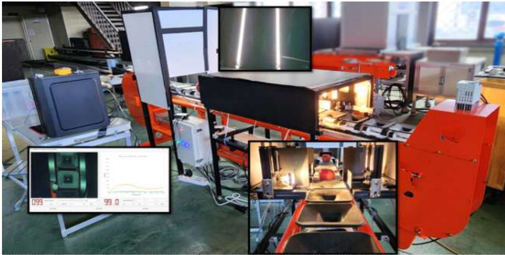
<컵 방식에서 과일크기인식부와 적정 광원과 분광 센서의 거리가 적용된 투과식 선별 시스템 구성 >
