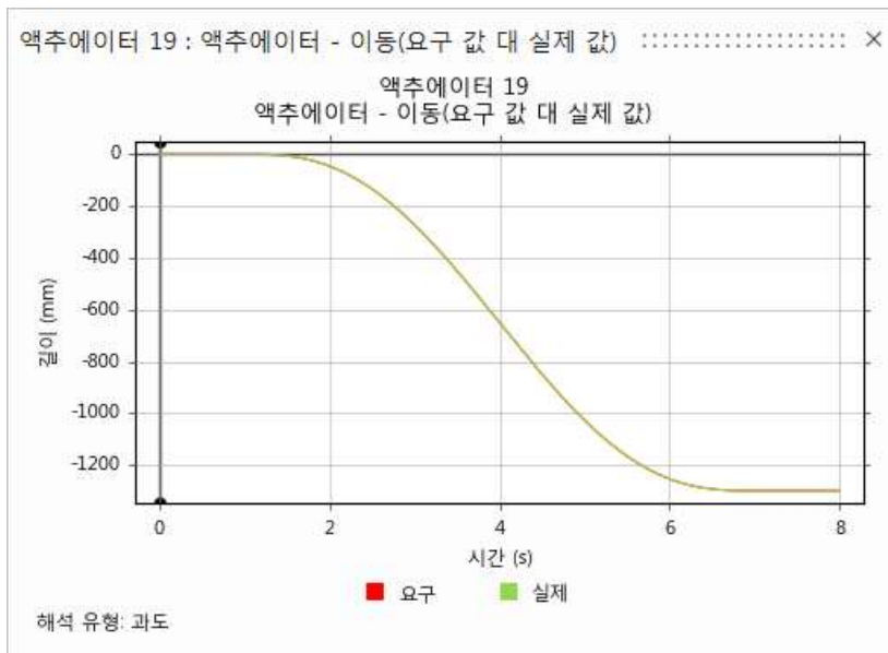
<푸셔 액추에이터 해석 결과(하중-시간)> <푸셔 액추에이터 해석 결과(변위-시간)> 그림 18. 디팔렛타이저 푸셔 작동 해석 결과
