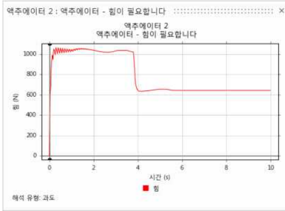
<액추에이터 해석결과(하중-시간) > <액추에이터 해석 결과(변위-시간)> <디팔렛타이저 상하 리프트 작동 해석 결과>
