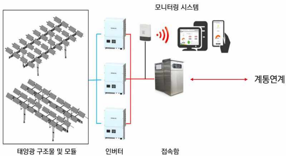
그림 101 영농형 태양광 시스템 전기 및 모니터링 설비 종합 구성도
