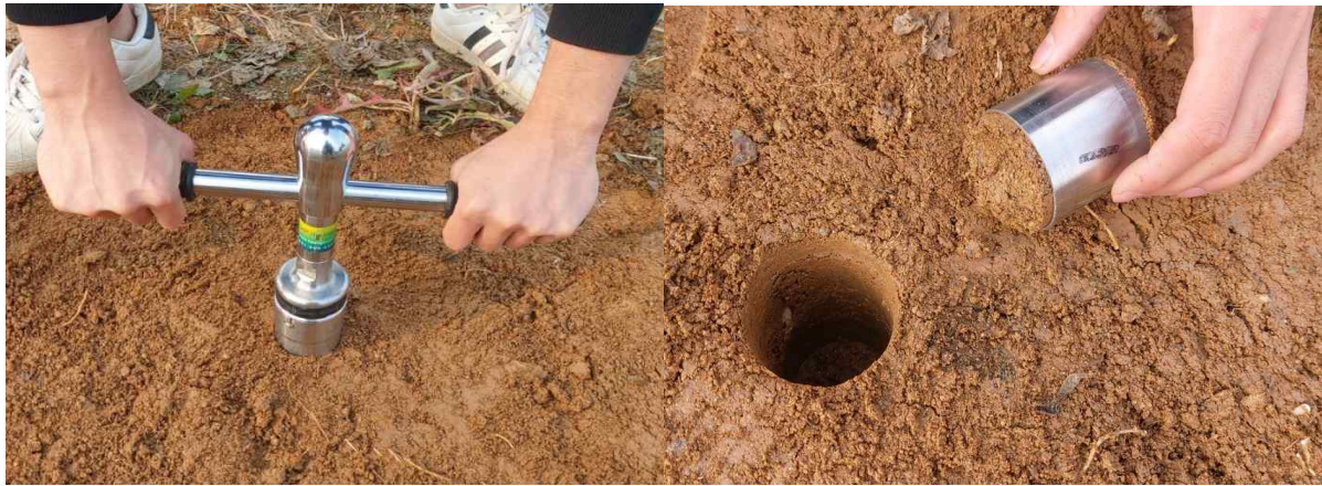
그림 2 현장밀도 시험 및 샘플링
