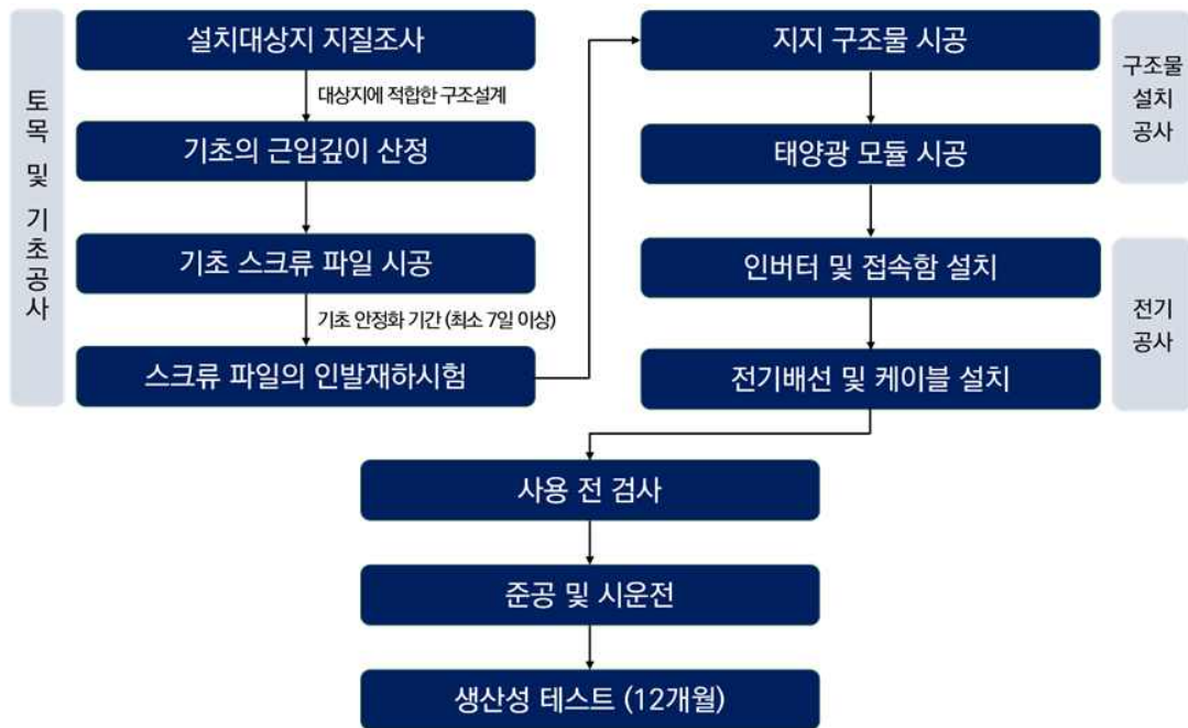
그림 99 영농형 태양광 시스템 현장 설치 및 시공 종합 흐름도
