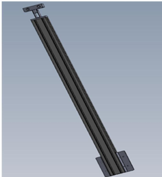
그림 33 영상 수집을 위한 카메라 지그 시스템
