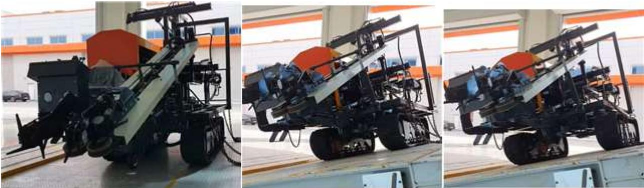
그림 197 전도시험 장면. 좌측부터 수평, 수평제어 작동 전, 작동 후
