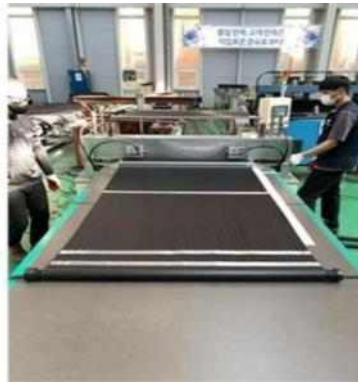
[그림 2-8. PVT 제품 조립 현장 사진_헤더용착]
