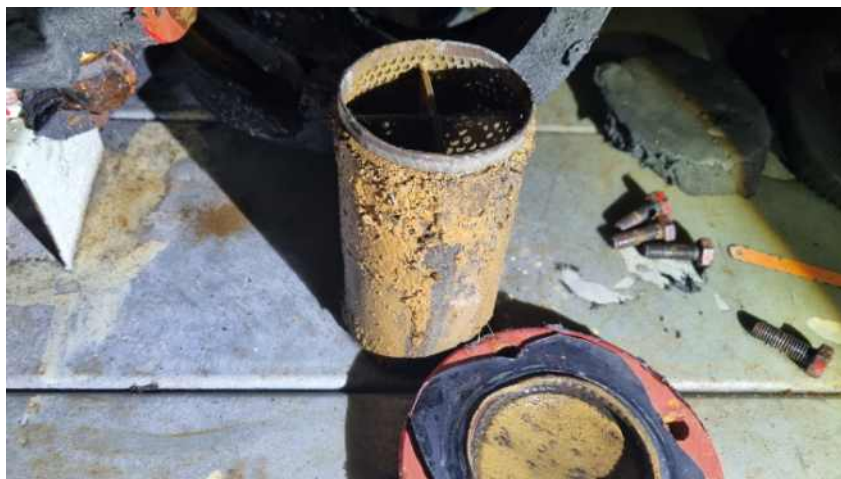
[그림 3-28. 스트레이너 진흙 사진]
