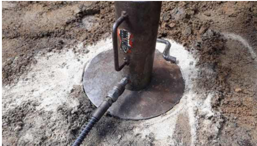
[그림 2-11. 평판재하 시험 현장 사진]
