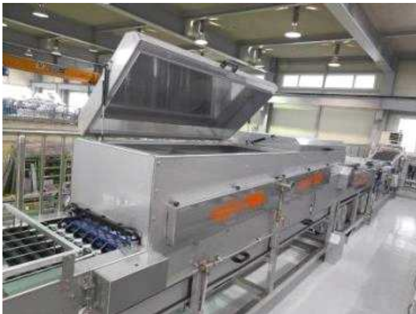
그림 1-2. 세척건조부의 내부와 Attached chain을 관찰하기 위하여 상부 뚜껑을 열은 상태 사진.
