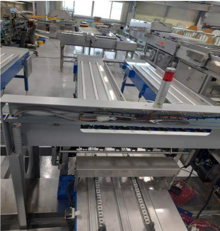
그림 1-19. 계란선별기의 트레이 디스펜서부 전면부와 이상 작동의 경보 발생기 근접 사진.
