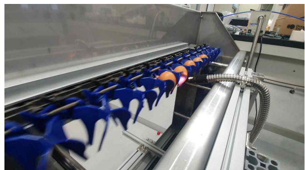
그림 1-12. 장착된 계란 이송 시스템 2.
