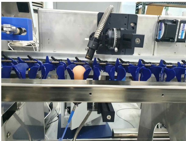
그림 3-3. 센싱 모듈과 계란 측정 방식.
