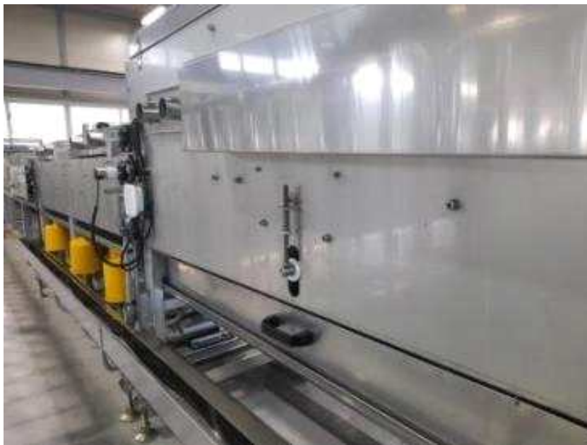
그림 1-6. 세척건조부의 체인 인장을 계측할 수 있는 Tension bar (텐션바)의 반대편 근경 사진.
