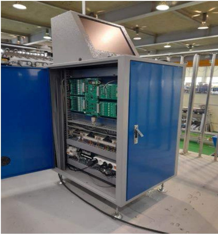
그림 1-12. 측정된 계란의 무게를 수신하는 중앙제어부의 A/D, D/A board의 내부 전경.
