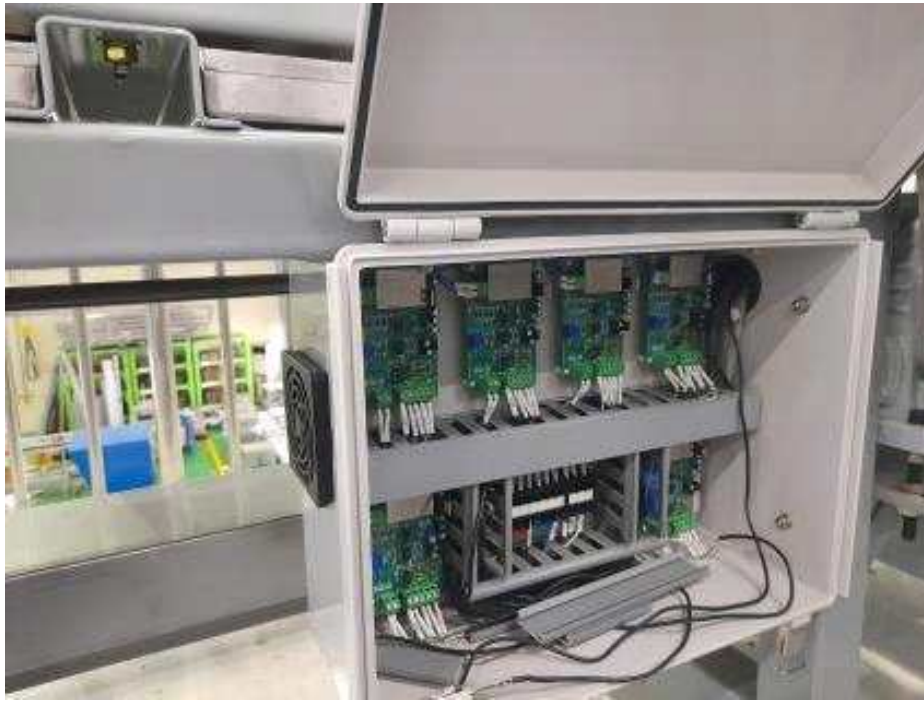
그림 1-10. 선별기의 계란 무게 측정 Analog data 수신과 송신을 위한 PCB board box 내부의 근접 전경.
