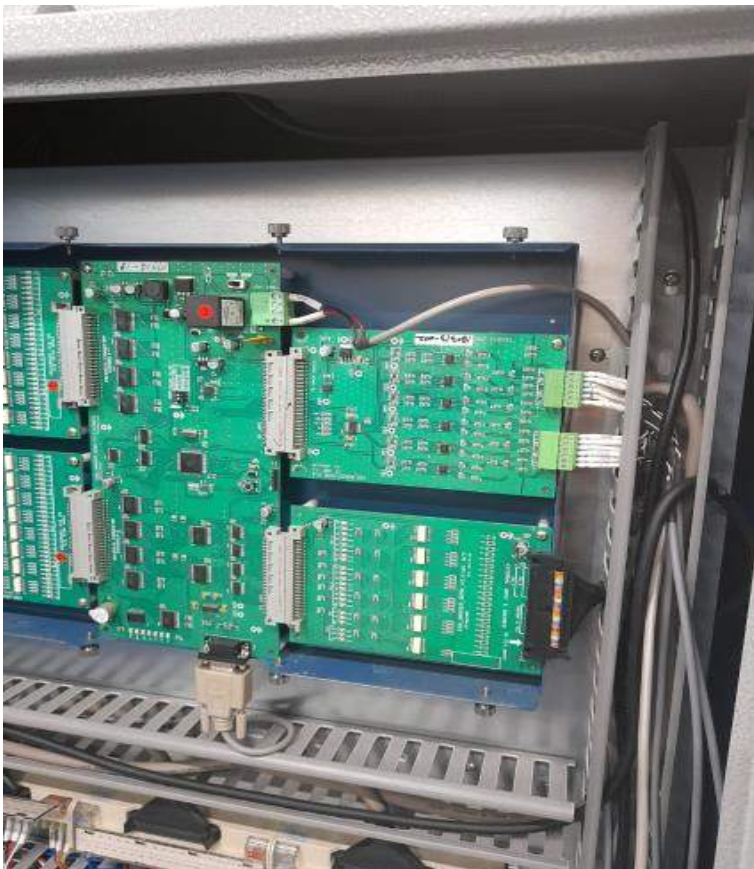
그림 1-13. 측정된 계란의 무게를 수신하는 중앙제어부의 A/D, D/A board의 근접 전경 사진.
