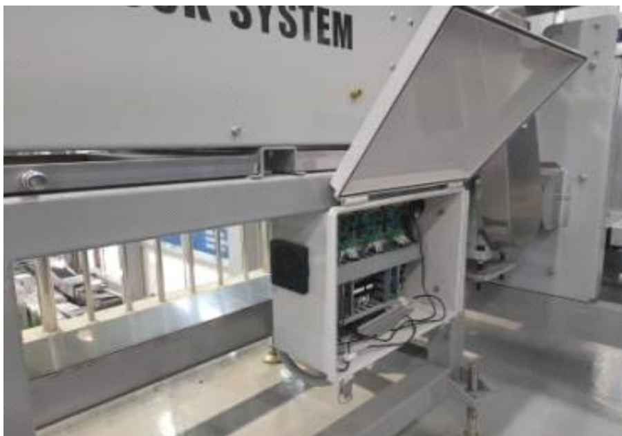
그림 1-9. 선별기의 계란 무게 측정 Analog data 수신과 송신을 위한 PCB board box 내부 전경.
