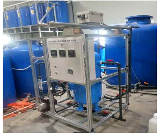
[그림 2.3] 강릉 자체 테스트베드 온실 현장(전체면적: 700평, 재배작목: 토마토·딸기, 사용배지: 압면, UV 살균모듈구조: Swirl 타입, 처리용량: 1톤 및 2톤/시간)
