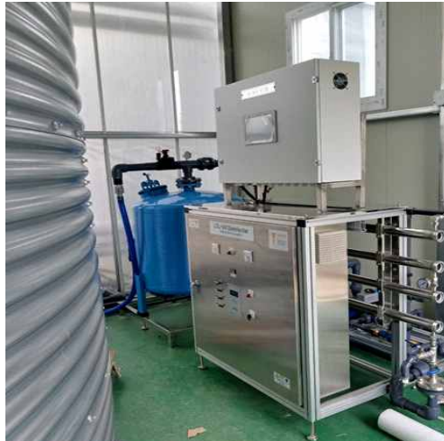
[그림 2.4] 마산 진동면 K 농가 실증현장(전체면적: 6000평, 재배작목: 파프리카, 사용배지: 코코 피트, 정식일: 2019년 8월 10일, UV살균모듈 구조: Swirl 타입, 처리용량: 2톤/시간)
