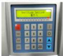
④ AMP를 눌러 amplitude(bacteria인 경우 20-25%로 설정)를 설정한다.
