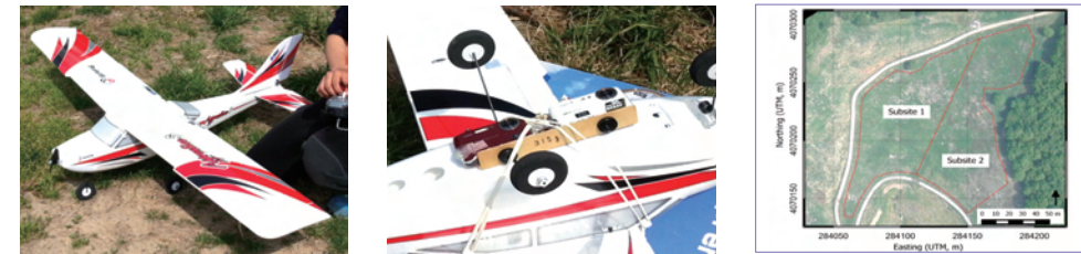
그림 10-4 산지초지 관측을 위하여 사용된 무인항공기(좌)와 무인항공기에 부착된 카메라(중), 항공촬영영상(우)
