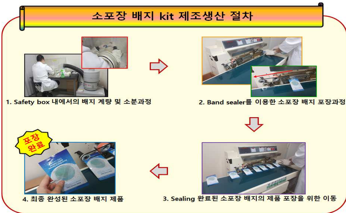
그림8. 소포장 배지 제조생산 과정
