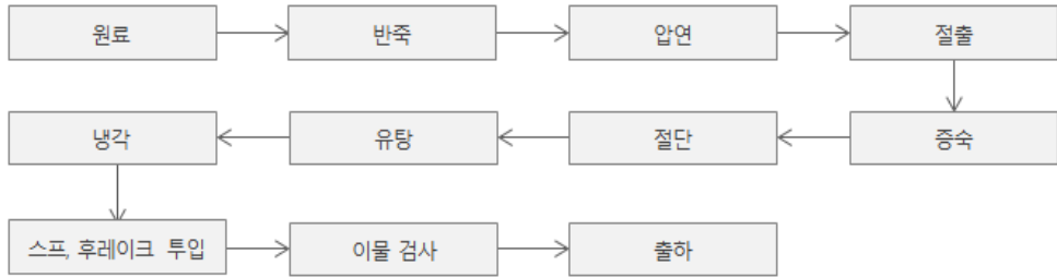
[그림 3-1] 라면의 제조 공정
