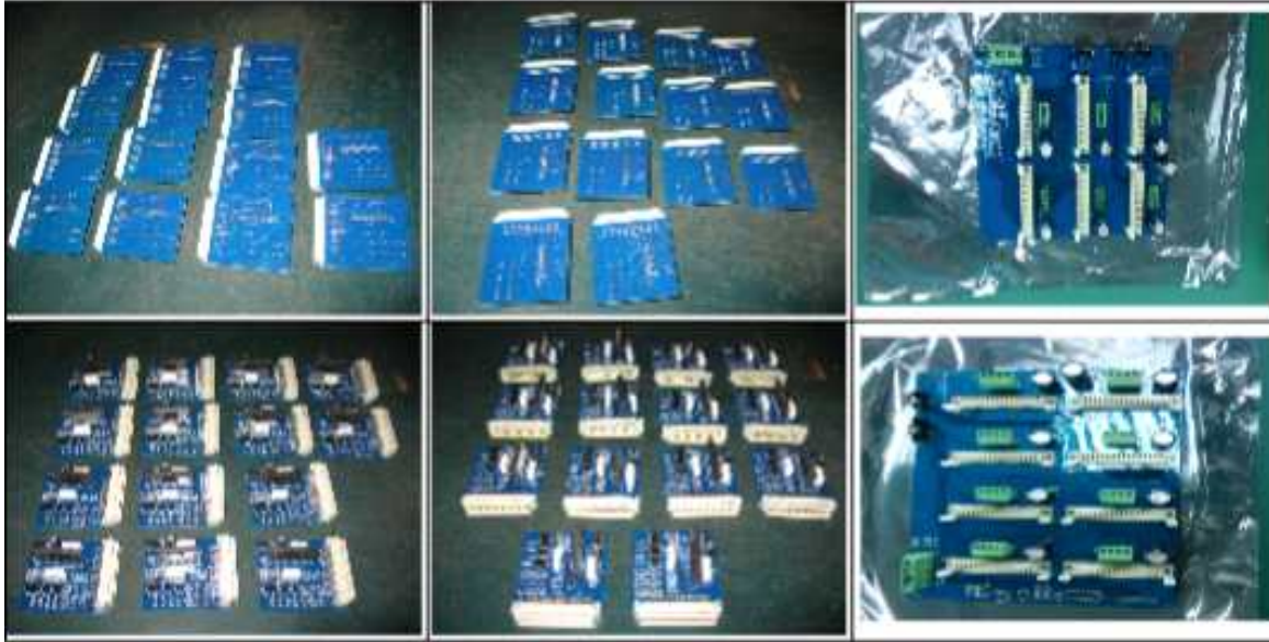
<그림 3-05-47> 분류 계량 관련 장치별 컨트롤러 PCB 조립 결과
