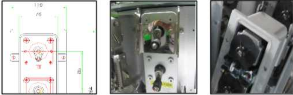
<그림 3-05-22> 개폐용 STEPPING MOTOR 도면(좌), 조립앞사진(중), 조립뒤사진(우)
