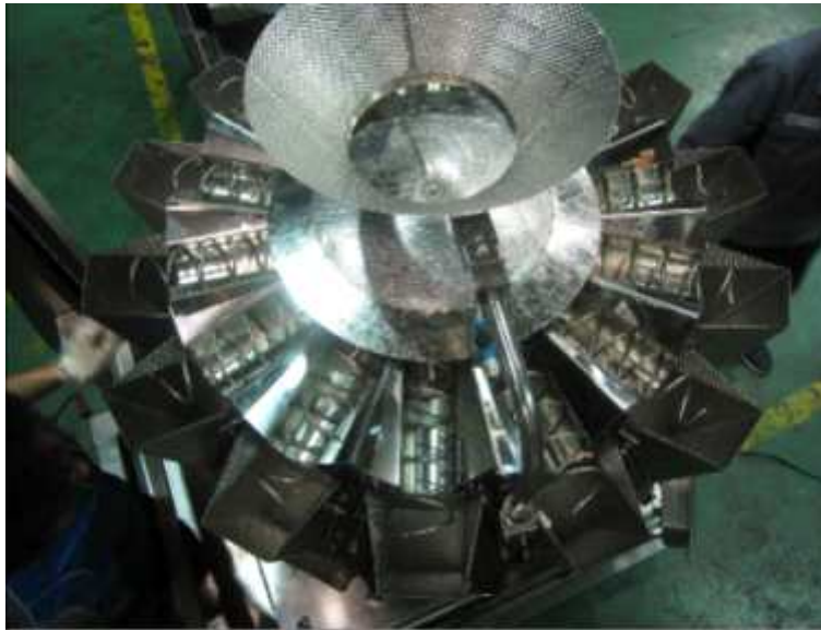
<그림 3-05-32> 멀티헤드스케일 조립 완성 사진
