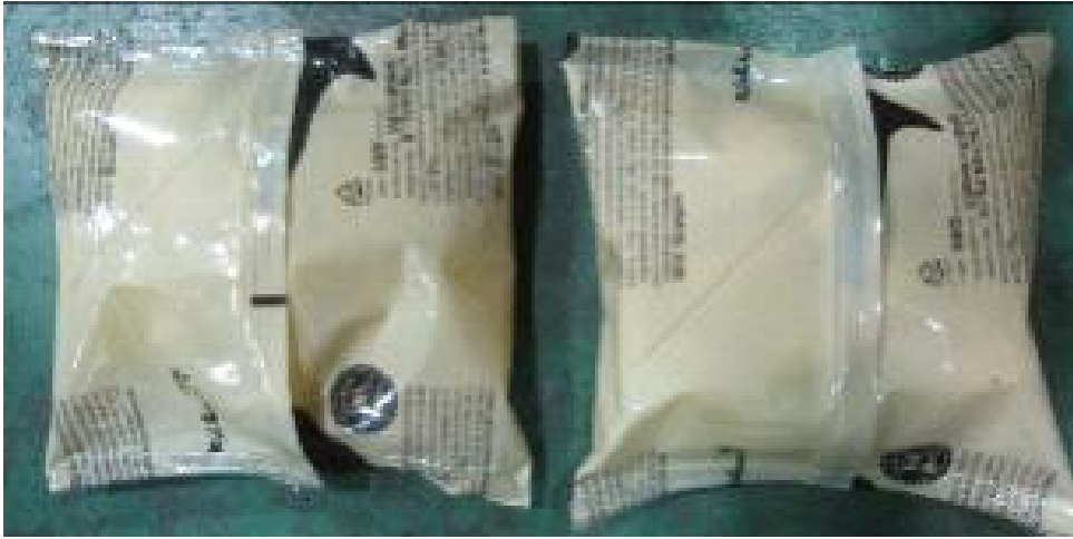
<그림 3-05-69> CENTER SEALING 포장 상태
