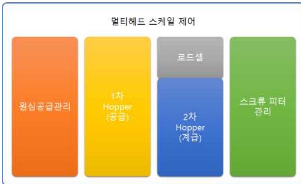
<그림 3-03-13> 멀티헤드 스케일부 동작 구조도
