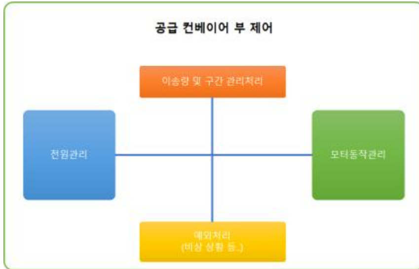
<그림 3-03-12> 공급 컨베이어부 동작 구조도
