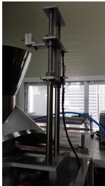
<그림 3-05-76> 버티컬 포장장치 개량(좌), 진공장치 Ass'y(우)
