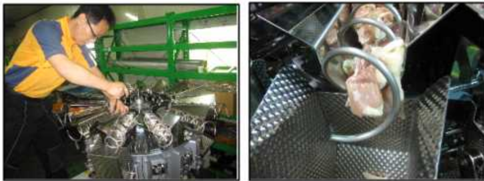
<그림 3-05-19> SCREW SPRING공급 ASS'Y 조립광경(좌), TEST(우)
