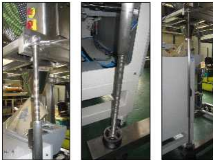
<그림 3-05-84> 높낮이조정 상부(좌),하부(중), 고정지지한 상태(우)
