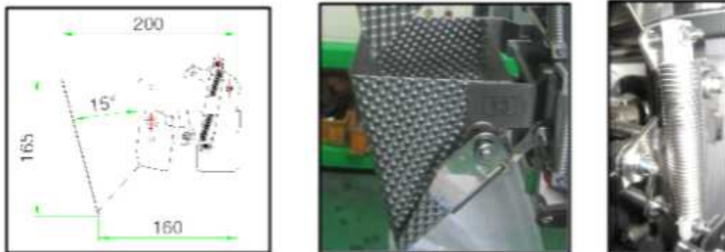
<그림 3-05-23> 계량HOPPER 도면(좌), 조립사진(중), GATE SPRING(우))
