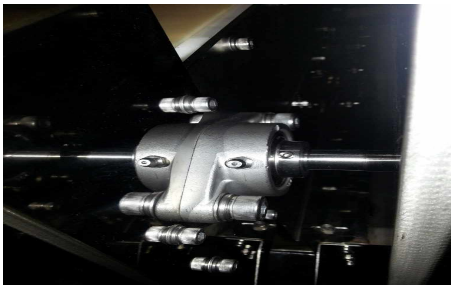
<그림 3-K6-13> 종/횡 구동스프로켓 동력 전달부 사진
