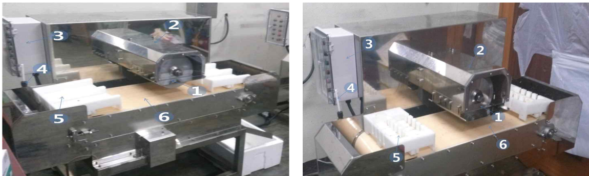
1-절단날, 2-절단날 케이스, 3-컨트롤박스, 4-스타터, 5-트레이, 6-컨베이어 <그림 3-K6-24> 종/횡 절단장치 전체 조립사진
