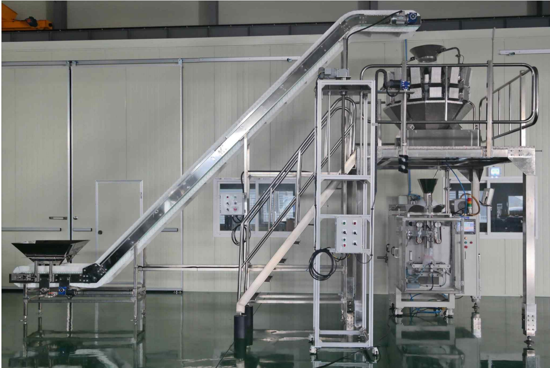
<그림 3-05-94> 닭고기 자동조합계량/포장 장치 개발 조립 완성
