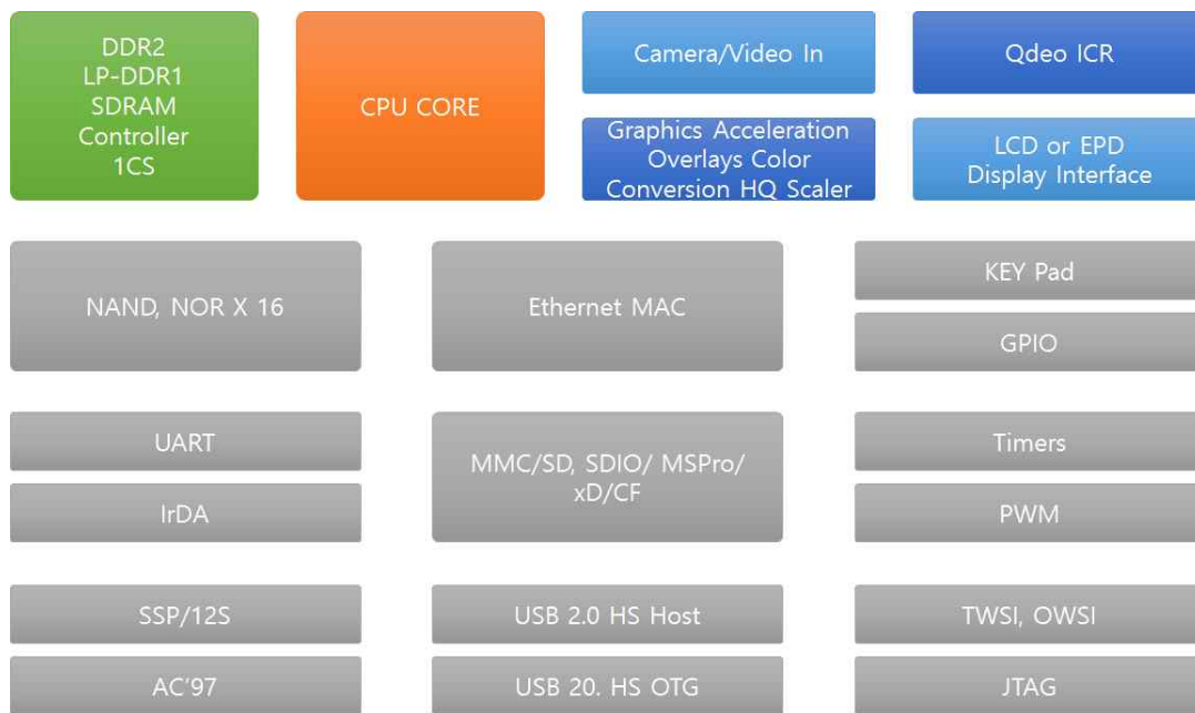
<그림 3-03-9> Embedded 단말 개발을 위해 적용 검토한 Reference Core-Logic 구성도
