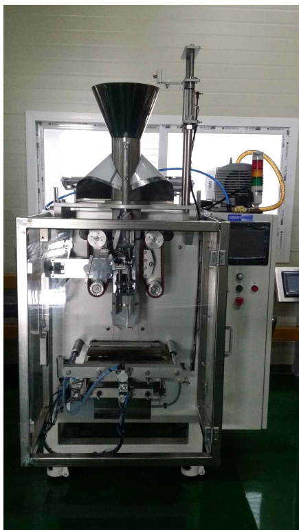
<그림 3-05-76> 버티컬 포장장치 개량(좌), 진공장치 Ass'y(우)
