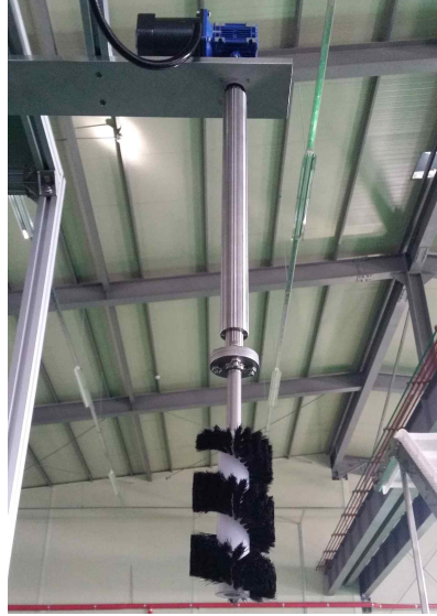
<그림 3-05-91> 버틸컬형 포장장치 Hopper 청소 솔 및 Machine cleaning piping 구동 축
