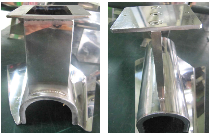
<그림 3-05-37> SCREW SHUTER 개선 전(좌), 개선 후(우)
