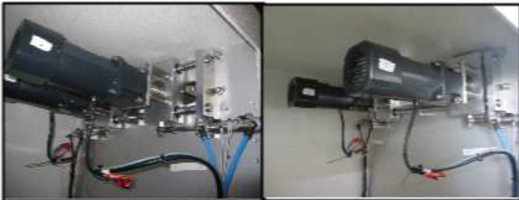
<그림 3-05-64> TIMMING BELT 구동 MOTOR-BRAKE 부착(좌), 벌어진상태(우)
