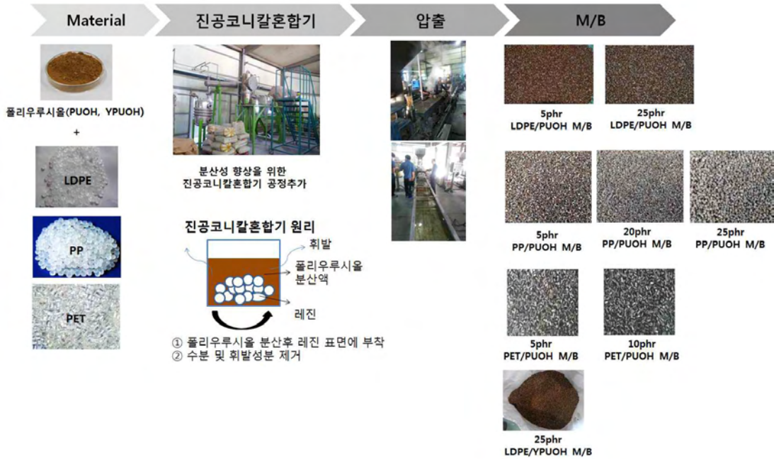
그림 68. 진공코니칼 혼합방식을 통한 최적함량의 고농도 M/B 제조
