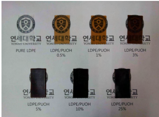
그림 100. LDPE/PUOH 사출시편의 광학적 특성 (900 \mu\text{m}\pm 5 )
