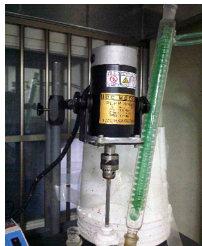
그림 145. Power motor (풍림 PLHP 400HS)
