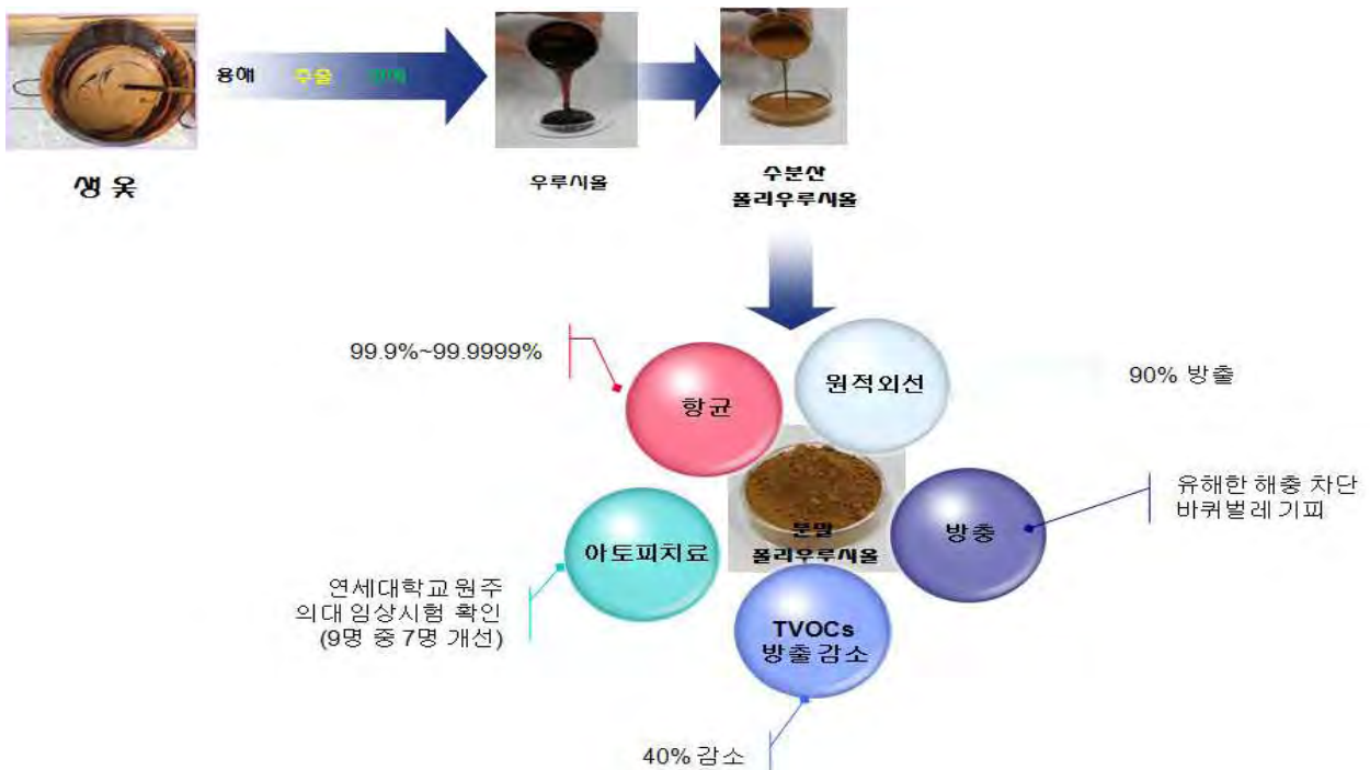
그림 5. 폴리우루시올의 제조 방법 및 효과
