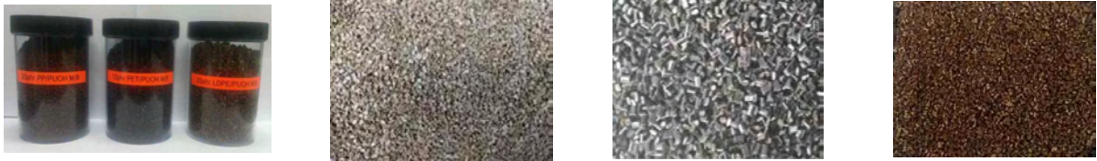
그림 6. 폴리우루시올 함유 M/B 개발 (왼쪽부터 PP, PET, PE)
