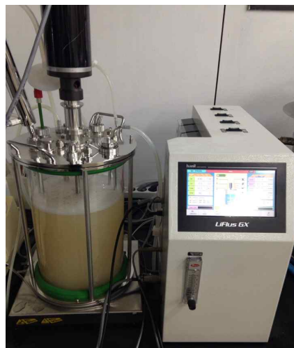
Fig. 20. MRPs 발효물 제조에 사용된 Bio-Reactor
