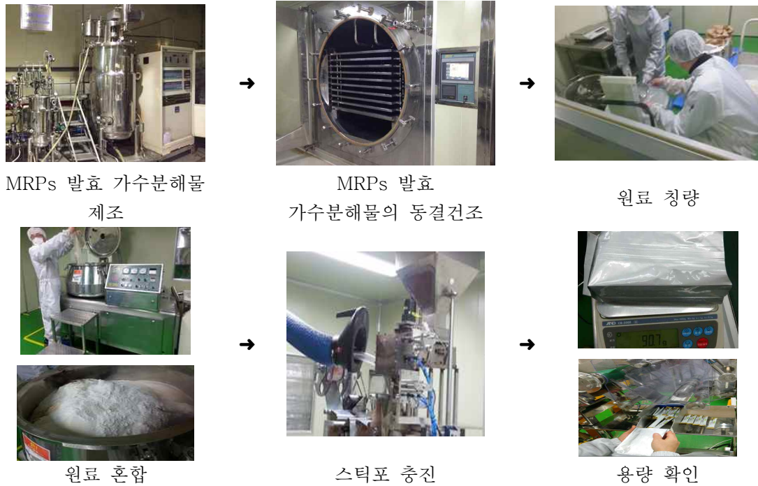
Fig. 26. 프로바이오틱 MRPs 혼합유산균 제제의 제조과정
