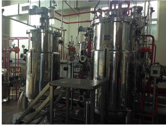
Fig. 22. MRPs와 MRPs 발효물 소량생산 시험에 사용된 발효조 (재)춘천 바이오 산업 진흥원
