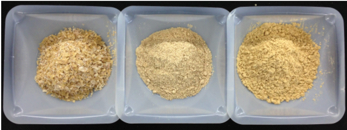
그림 26) 밀기울, Hammer mill 분쇄 밀기울, 압출성형 기류분쇄 밀기울
