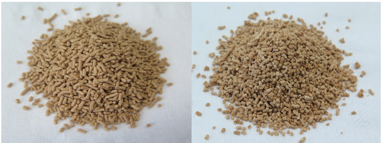
그림 39) 과립 공정 시험 시료, 물을 결합액으로 사용한 시료(좌), 에탄올을 결합액으로 사용한 시료(우)
