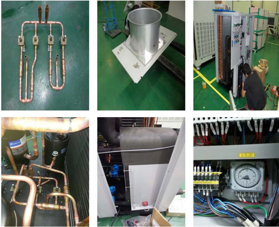
그림 19. 잉여열 회수형 제습난방기의 요소별 제작 공정
