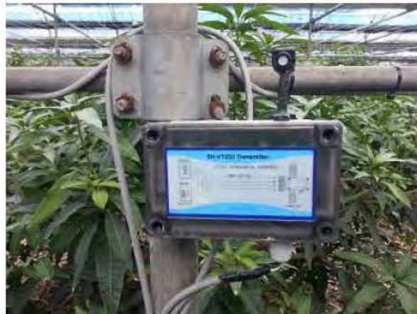
그림 24. 실험 온실 내외부 장착 온도, 습도, CO2 센서
