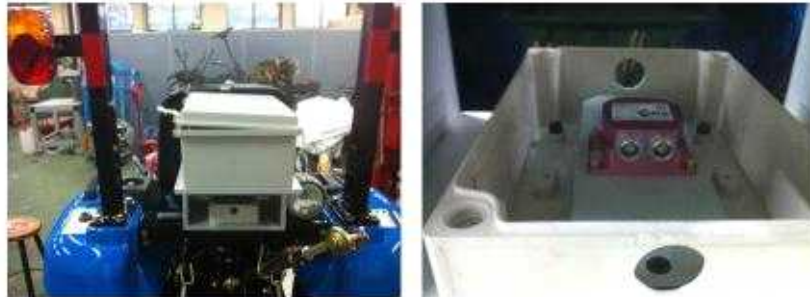
그림 3-3-7 방향각 측정을 위한 IMU system
