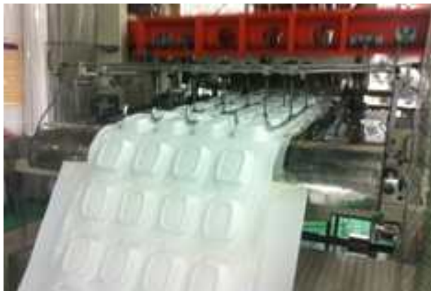
그림 35 트레이의 형태로 컷팅하는 모습
