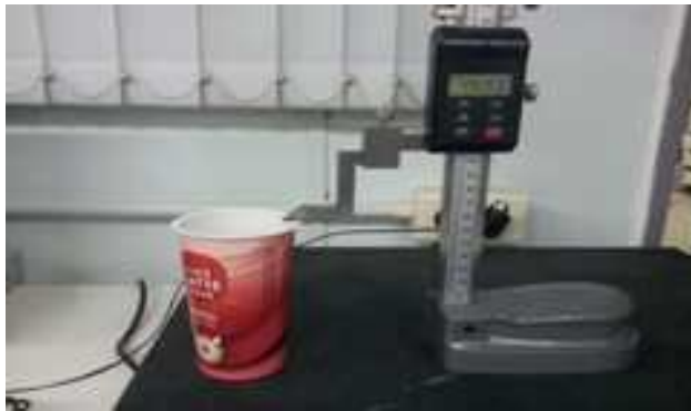
그림 37 Height gauge를 이용한 높이 측정
