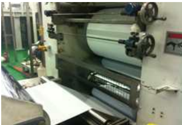
그림 31 압출 후 T-DIE를 통한 Sheet 성형
