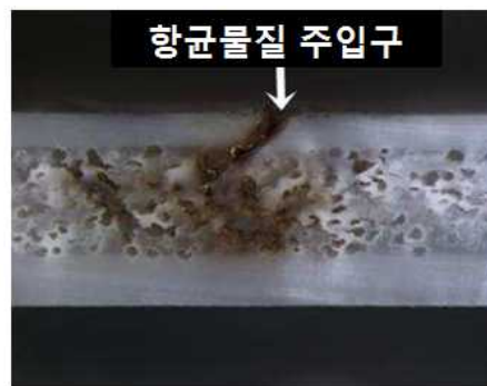
그림 94 항균물질이 주입된 다층시트의 단면 및 주입구(40배)
