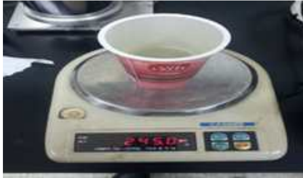
그림 39 전자저울을 이용한 시제품 무게 측정
