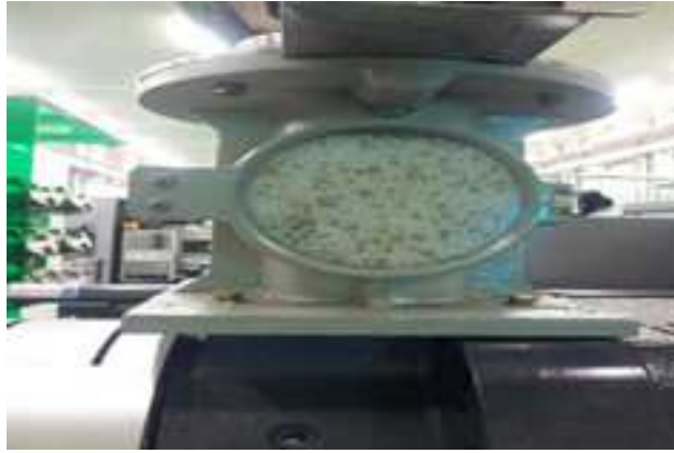
그림 27 배합된 재료가 호퍼 안에 들어간 모습
