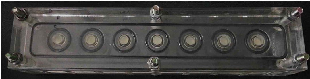
그림 67 기체상태의 천연항균물질의 MIC를 측정하기 위해 개발한 제작틀 (container)
