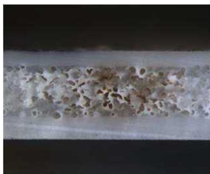
그림 94 항균물질이 주입된 다층시트의 단면 및 주입구(40배)
