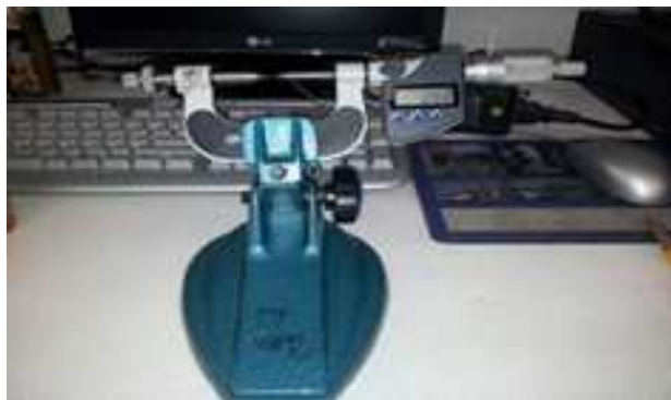
그림 38 Micrometer를 이용한 두께 측정
