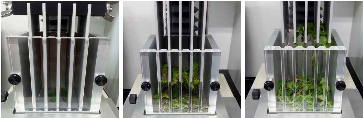
그림 13 좌측부터 깻잎, 상추, 새싹 채소 샘플의 물성을 측정하는 모습
