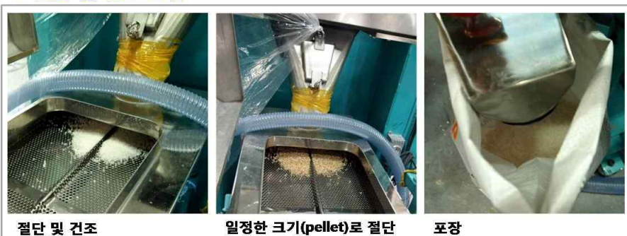
그림 88 구연산과 시나몬 에센셜 오일이 각각 함유된 마스터배치 제조 공정도
