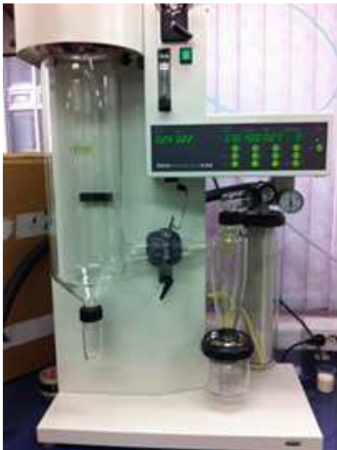
그림 5. 분무건조기(spray dryer) 및 제조된 미세캡슐 표 2 미세캡슐화를 위한 spray drying 조건
