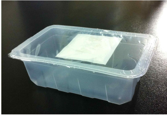
그림 93 두부 용기에 sachet를 적용한 시제품 모습
