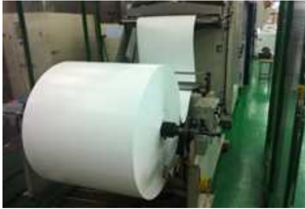
그림 33 성형기에 Sheet 투입하는 모습
